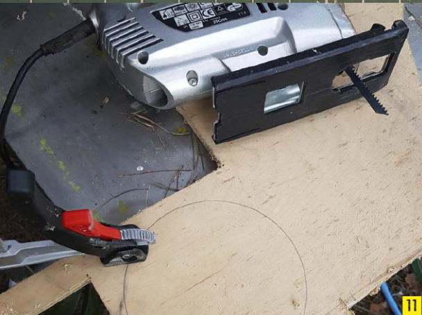
7. Cylinder główny z deseczką pełniącą funkcję suwaka, 8. Cylinder zamocowany do swojego suportu, 9. Mechanizm zmieniający kierunek pracy na poprzeczny, 10. Wateczki drewniane, 11. Wycinanie koła zamachowego ze sklejk, 12. Wiercenie wiertłem stolarskim \varnothing 30 milimetrów
