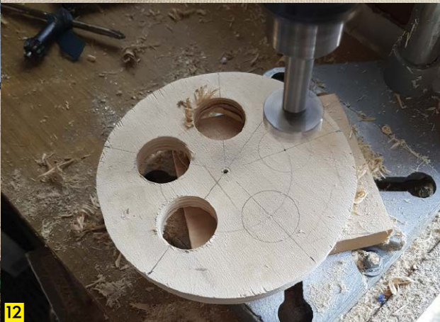
7. Cylinder główny z deseczką pełniącą funkcję suwaka, 8. Cylinder zamocowany do swojego suportu, 9. Mechanizm zmieniający kierunek pracy na poprzeczny, 10. Wateczki drewniane, 11. Wycinanie koła zamachowego ze sklejk, 12. Wiercenie wiertłem stolarskim \varnothing 30 milimetrów
