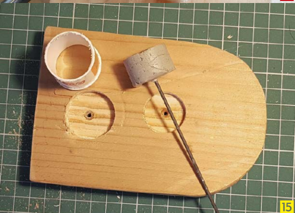
13. Przygotowanie do uformowania cylindra, 14. Formy do zrobienia tłoków i tłoczyska, 15. Tłok wyjęty z formy, 16. Poprawki tłoka można zrobić papierem ściernym
