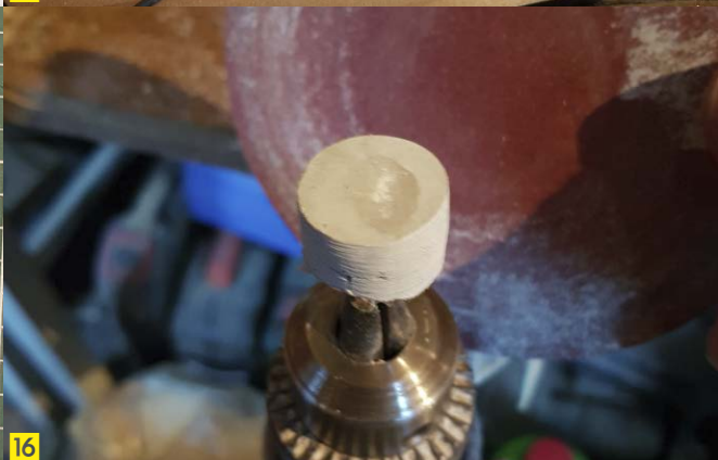
13. Przygotowanie do uformowania cylindra, 14. Formy do zrobienia tłoków i tłoczyska, 15. Tłok wyjęty z formy, 16. Poprawki tłoka można zrobić papierem ściernym
