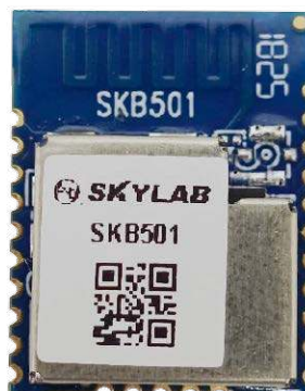
Fotografia 5. Moduł BLE z serii SKB501-CSPI marki SKYLAB
