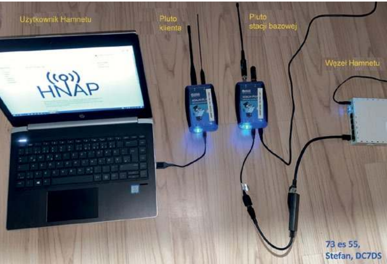
Fot. 2. Łącze z wykorzystaniem radiostacji Adalm Pluto
