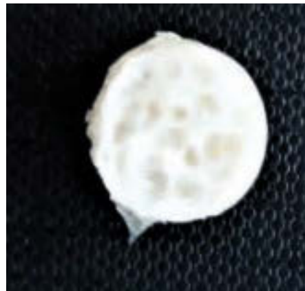
Rys. 4. Przekrój hydrożelu domieszkowanego białkiem ALP
