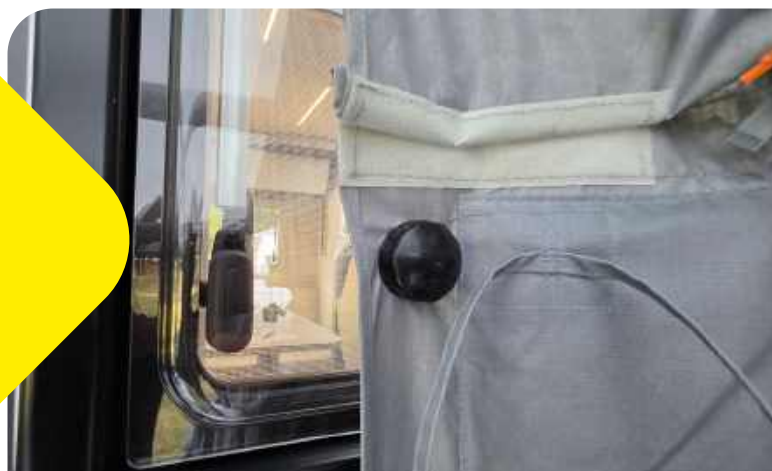
Dometic Limpet Fix Kit pomaga w zamontowaniu przedsionka do ścian kampera; okrągły, obrotowy dodatek w postaci przyssawek instalowanych w gotowe otwory przedsionka
