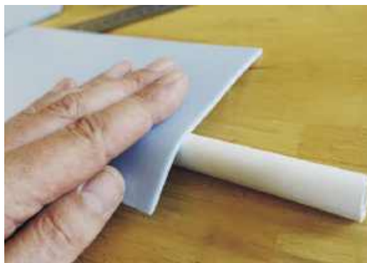
Sposób na wygięcie płaszczyzn nośnych
