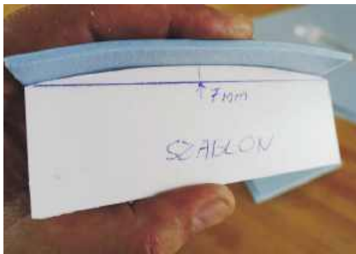
Sprawdzamy promień wygięcia
