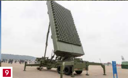
6. Stacja radarowa OTH w pobliżu Czarnobyla; 7. Obraz powierzchni Ziemi uzyskany za pomocą radaru SAR z satelity SEASAT; 8. System radarów pasywnych Twinvis; 9. Nowoczesny chiński radar typu phased array z doniemanymi możliwościami wykrywania samolotów stealth
