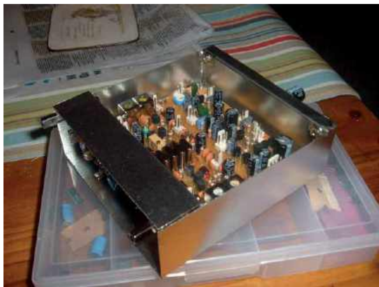
Zmontowany TRX (w środku moduły HF i LF, z przodu moduł VFO)
