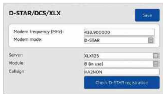
Rys. 2. Konfiguracja połączenia z reflektorami XLX
