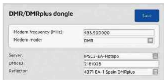
Rys. 1. Konfiguracja połączenia z siecią DMR+
