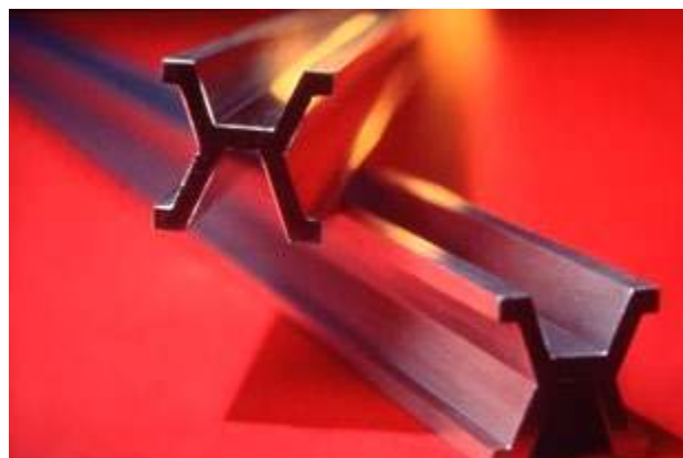
Wzorzec metra, pręt o długości wynoszącej 102 cm, w przekroju poprzecznym ma kształt litery „X” i wymiary 16 mm x 16 mm, na którym zaznaczono linie, ( https://pl.wikipedia.org/wiki/Metr )
