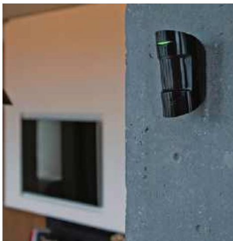
Urządzenia alarmowe porozumiewające się drogą radiową mocuje się po prostu w wybranych miejscach – nie potrzebne są żadne prace mokre czy kucie ścian w pomieszczeniach, by poprowadzić przewody. ABAKS-SYSTEM
