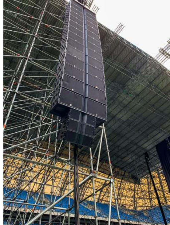
System główny składał się z dwóch gron zestawionych z 14 elementów K1 i 3 elementów KARA.
