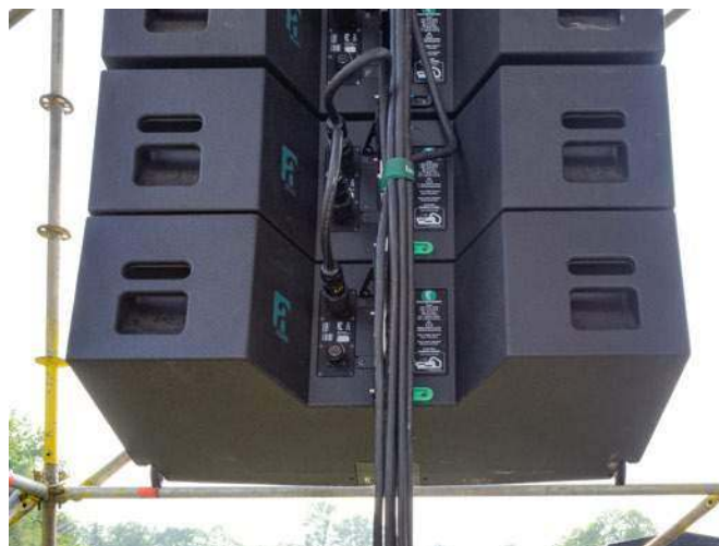
Waga modułów nie przekracza 65 kg (63 kg dla LR28I110).
