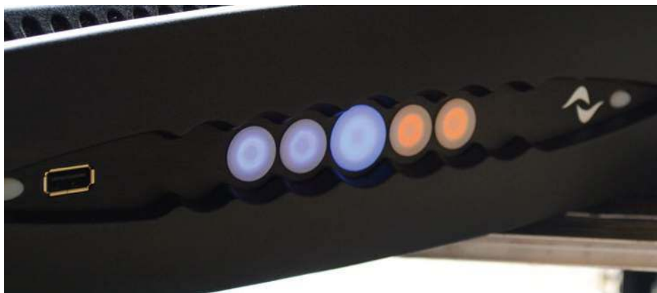
Jeśli wzmacniacz jest gotowy do pracy, środkowe części przycisków odmutowanych kanałów świecą na niebiesko, a kanałów wyciszonych na pomarańczowo.
