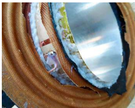
Nieudolna próba naprawy głośnika przy użyciu cewki kupionej jako zamiennik oryginalnej.
