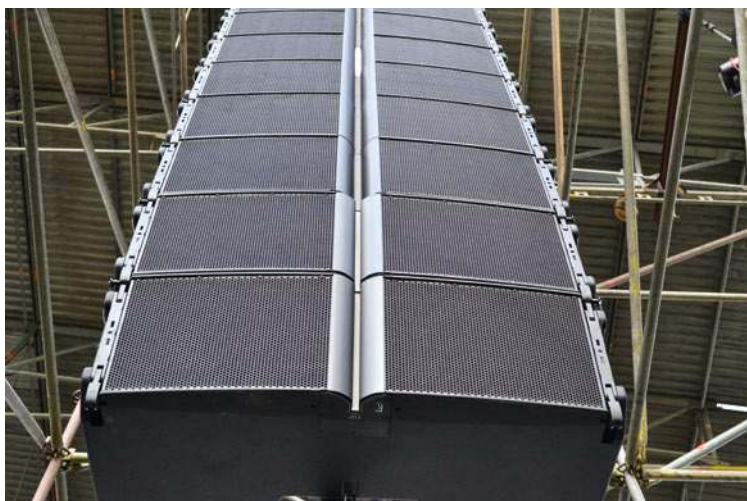
LR28 to trójdrożny wielkoformatowy system typu line array, składający się z dwóch modułów – LR28I80 o dyspersji horyzontalnej 80 stopni oraz LR28I110 o 110-stopniowej dyspersji.
