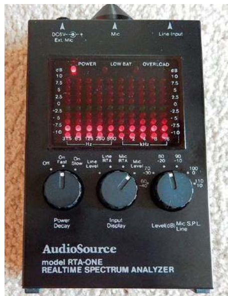
Wczesne „kieszonkowe” analizatory, typu IE30 czy RTA-One, charakteryzowały się niewielką tymczasową pamięcią, umożliwiającą „złapanie” jednego lub dwóch pomiarów.
