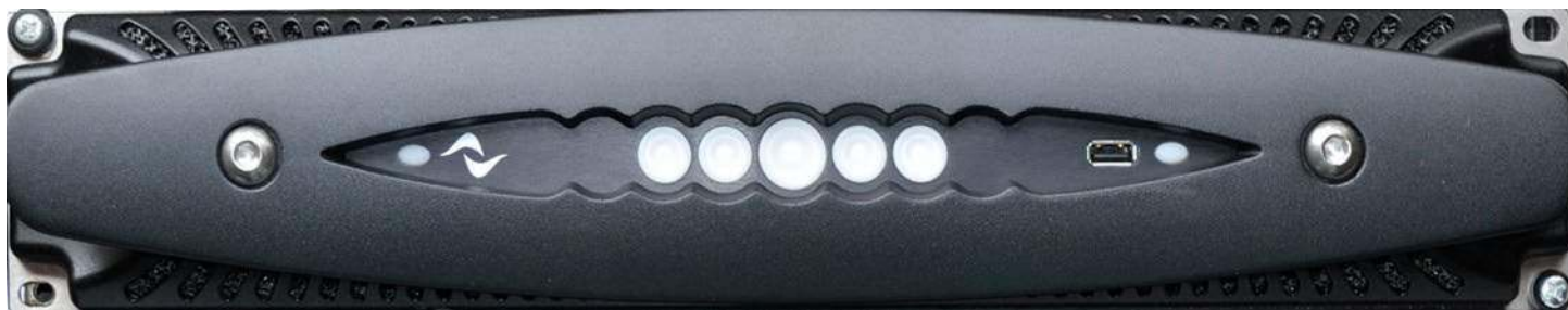
Panel przedni zawiera tylko 5 umieszczonych centralnie, okrągłych podświetlanych przycisków oraz dwa mniejsze z lewej i prawej strony.
