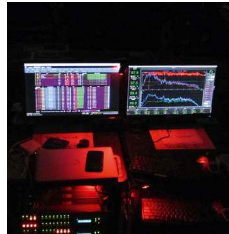
Dwukanałowe analizatory audio o wysokiej rozdzielczości są obecnie standardowym narzędziem w pracy każdego realizatora i inżyniera systemu.
