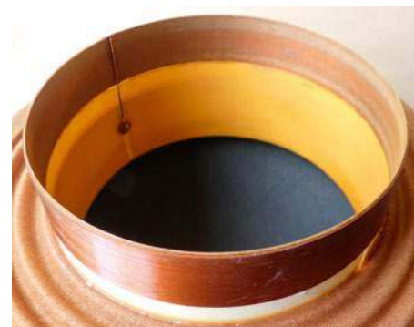
Cewka Beyma z głośnika 15G 450, nawinięta drutem płaskim na sztorc.
