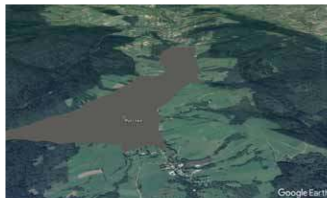
Ryc. 15. Przypuszczalny zasięg jeziora zaporowego Kąty-Myscowa przy założeniu, że korona zapory znajdzie się na wysokości 356 m n.p.m.
