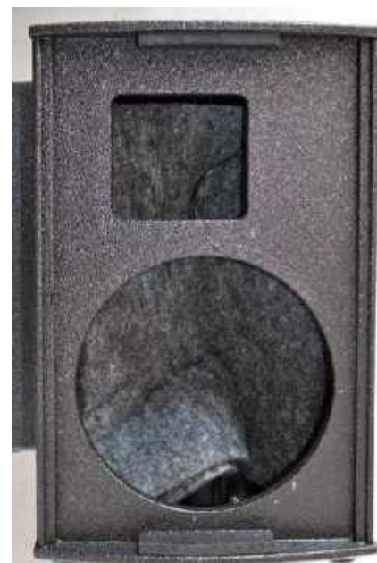
Wnętrze nadstawki jest wyścielone matą z wełny mineralnej.
