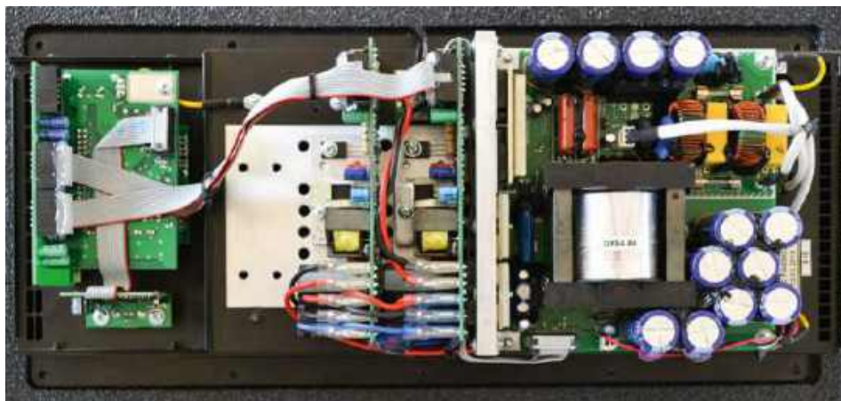
Subbas wyposażony jest w dwie końcówki mocy: 700 W (przy 4 omach), zasilająca głośnik suba, oraz 350 W (przy 8 omach), do napędzania pasywnej nadstawki.
