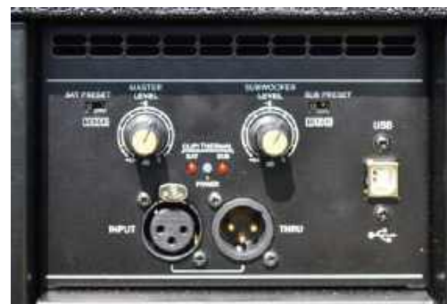
W górnej części panelu znajdziemy dwa potencjometry, dwa trójpozycyjne przełączniki wyboru presetu brzmieniowego, trzy LED-owe kontrolki, gniazda sygnałowe oraz USB.
