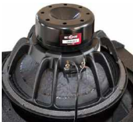
M1sub to klasyczna konstrukcja typu bass-reflex z głośnikiem B&C o średnicy 12”.
