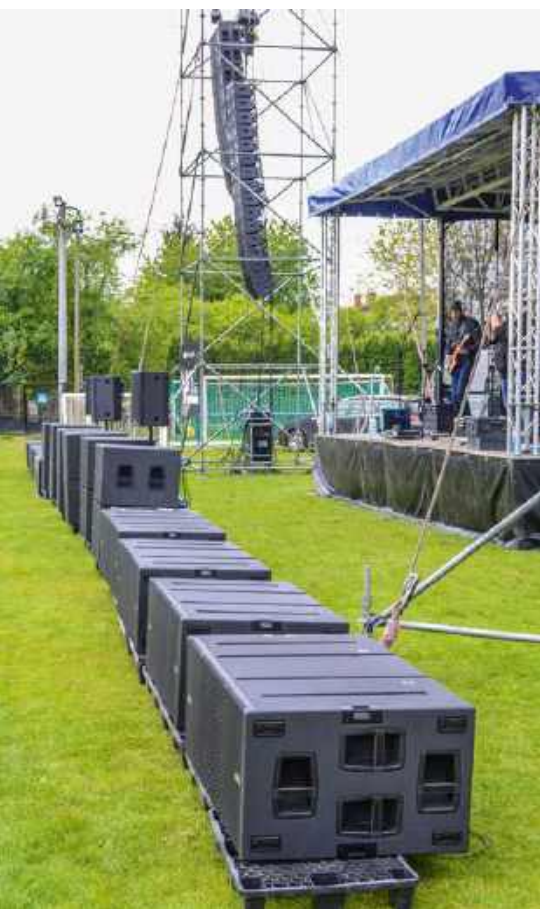
Systemy L208 i L212 w dole pasma wsparte były 12 subbasami VIO S118R i 8 subami VIO S218 – w jednej linii przed sceną (S118R stakowane po dwa).
