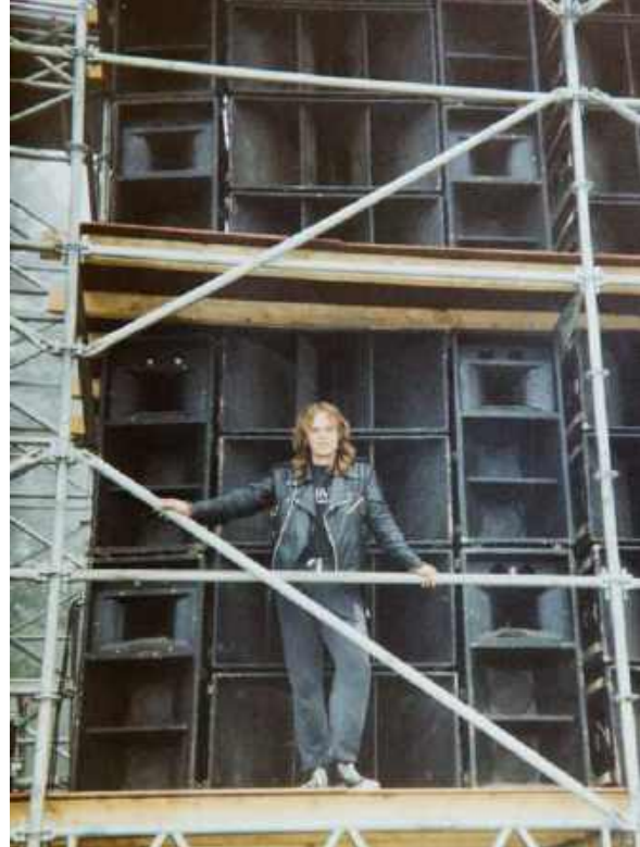
W przypadku koncertów plenerowych lub dużych festiwali kolejne warstwy głośników ustawiano wwyż na rusztowaniu wyposażonym w podłogę ze sklejk.
