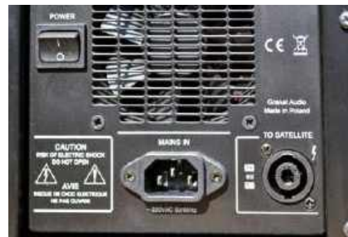
U dołu panelu znajduje się gniazdo zasilania typu IEC, gniazdo Spekon do podłączenia satelity oraz wyłącznik zasilania.
