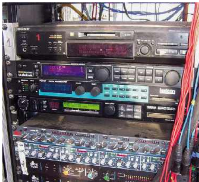
Poziom sygnału na wejściu urządzenia efektowego powinien być maksymalnie duży (aby zminimalizować szumy własne), ale nie może być przesterowany.
