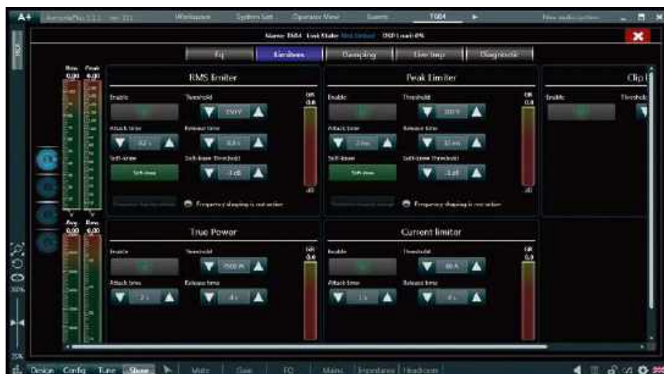
DSP serii T oferuje w sumie dwa limitery napięciowe, jeden prądowy i jeden mocy.
