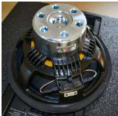
„Napęd” 101top stanowi 10-calowy woofer nisko-średnionowy firmy RCF...
