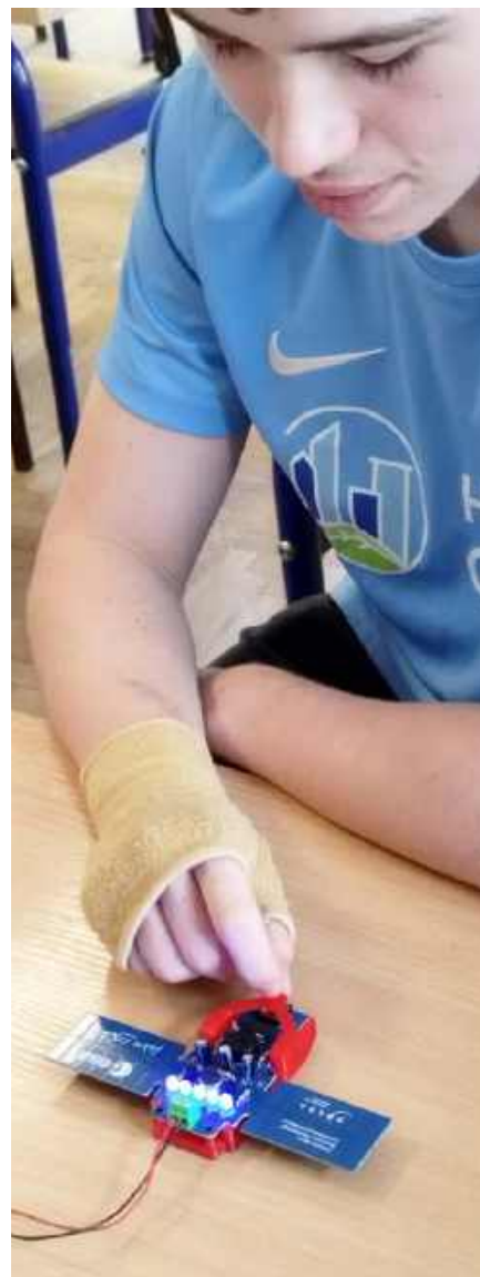
Fotografia 9. Uczeń Gustaw Szwed podczas testowania zestawu edukacyjnego „Klucz do Kosmosu”. Naciśnięcie przycisku S1 powoduje generowanie sygnałów alfabetu Morse’a
