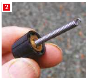
Rysunek 1. Zawsze sprawdzaj co wyrzucasz! Ta drucziana sprężyna do zaston jest przydatna do wszelkiego rodzaju prac – jest wytrzymała i sprężysta; Rysunek 2. Do odizolowanej druczianej sprężyny do zaston przymocowana jest gałka z tulejką o średnicy 4 mm; Rysunek 3. Widok uformowanego haczyka; Rysunek 4. Rezystor można łatwo usunąć z płytki posługując się jedną ręką, pozostawiając drugą ręką wolną do obsługi lutownicy
