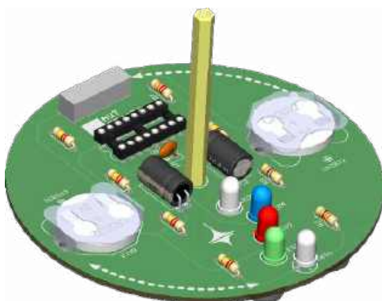
Rysunek 14. Bateria wsunięta do uchwytów. Górne powierzchnie baterii to ich bieguny dodatnie, które mają stykać się z blaszkami uchwytów
