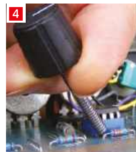
Rysunek 1. Zawsze sprawdzaj co wyrzucasz! Ta drucziana sprężyna do zaston jest przydatna do wszelkiego rodzaju prac – jest wytrzymała i sprężysta; Rysunek 2. Do odizolowanej druczianej sprężyny do zaston przymocowana jest gałka z tulejką o średnicy 4 mm; Rysunek 3. Widok uformowanego haczyka; Rysunek 4. Rezystor można łatwo usunąć z płytki posługując się jedną ręką, pozostawiając drugą ręką wolną do obsługi lutownicy
