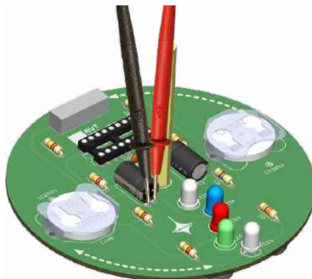
Rysunek 15. Pomiar napięcia zasilania na wyprowadzeniach kondensatora C3. Pamiętaj, aby przed pomiarem zewrzeć wyprowadzenia włącznika SW1 oraz zamontować baterie
