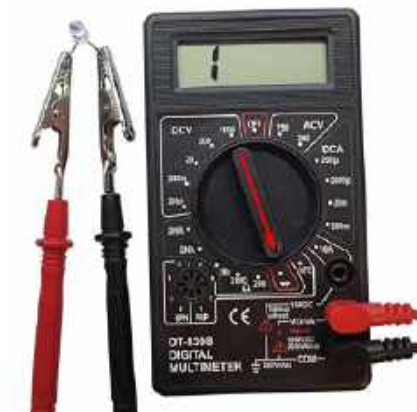
Fotografia 12. Sprawdzanie diody LED za pomocą multimetru ustawionego funkcję testowania diod. Po przyłożeniu sondy czerwonej do anody, a czarnej do katody, sprawna dioda LED powinna się zaświecić. Jeśli dioda ma odpowiednio długie (jeszcze nie przycięte) wyprowadzenia można się wspomóc krokodylkami
