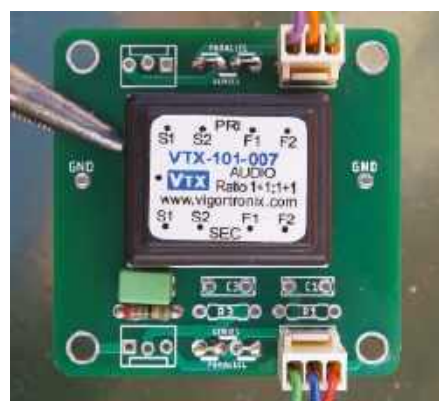
Rysunek 42. Płytką wzmacniacza z wyjściem liniowym z transformatorem VTX-101-007 o uzwojeniach połączonych równolegle. Elementy obwodu Złota to 13 kΩ i 6,8 nF
