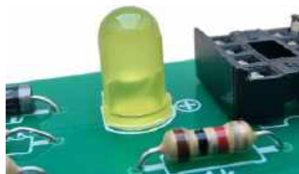
Fotografia 11. Przykład poprawnie zamontowanej diody LED. Płaskie ścięcie na obwodzie diody LED, symbolizujące katodę, musi pokrywać się z fragmentem linii prostej w obrysie komponentu zaznaczonym na płytce
