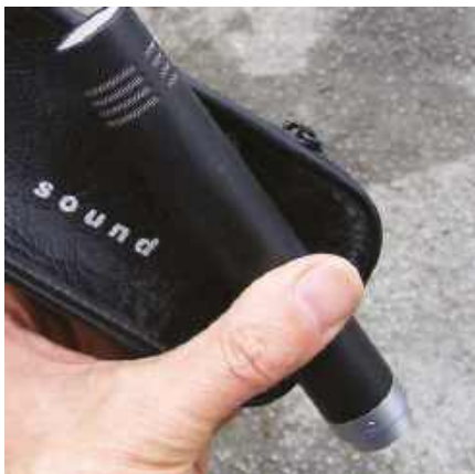
Rysunek 48. Mikrofon pojemnościowy Hebden Sound. Jak większość mikrofonów studyjnych zawiera on małe transformatory audio
