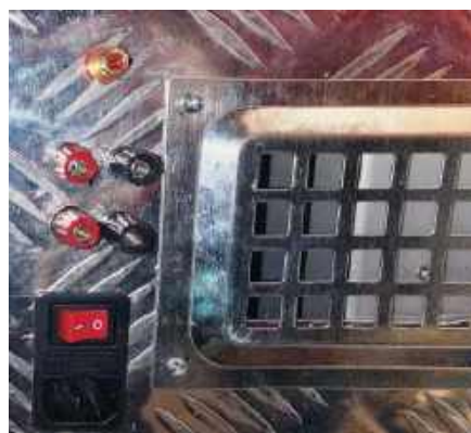
Fotografia 6. Na tylnym panelu znajdują się złącza dla wejścia zasilania (IEC), wejścia sygnału (RCA) i zacisków dla wyjść głośnikowych. Górne gniazda są przeznaczone dla obciążeń 2 Ω i 4 Ω, podczas gdy dolne gniazda zapewniają kompensację częstotliwości dla obciążeń 8 Ω
