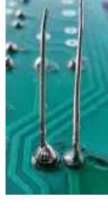
Fotografia 8. Montaż kondensatora elektrolitycznego C3: pamiętając o konieczności zachowania właściwej polaryzacji: a) zamontuj kondensator na leżąco; b) rozegnij lekko jego wyprowadzenia, aby nie wypadł po odwróceniu płytki do góry nogami; c) odegnij do pionu jedno z wyprowadzeń; d) przylutuj odgięte do pionu wyprowadzenie prostopadłe do płytki; e) odegnij do pionu drugie wyprowadzenie; f) przylutuj odgięte do pionu wyprowadzenie prostopadłe do płytki
