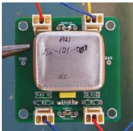
Rysunek 41. Transformator mikrofonowy VTX-101-003 z puszka ekranującą, o uzwojeniach połączonych szeregowo. Wartości obwodu Zobla wynoszą 680 pF i 15 kΩ. Transformator VTX-101-007 z szeregowo połączonymi uzwojeniami wtórnymi jest dołączony w ten sam sposób, z obwodem Zobla 13 nF/1,8 kΩ
