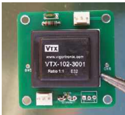
Rysunek 44. Zmontowana płytkę z transformatorem 3001. Elementy w obwodzie Zobel mają wartości 2 kΩ i 8,2 nF
