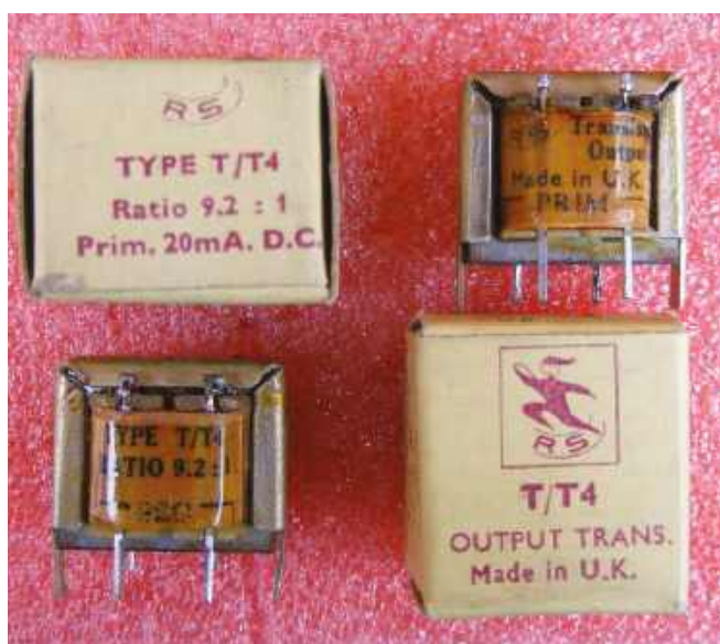
Rysunek 61. Transformator do wzmacniacza z rysunku 60. Od 1972 roku trzymam jeden taki w moim pudle z rupieciami – przepraszam, wśród „zasobów badawczo-rozwojowych”
