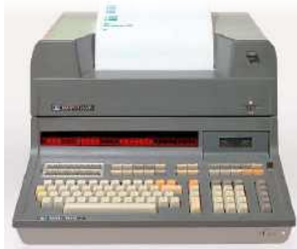
Rysunek 7. Programowalny kalkulator/komputer HP 9830A z 1972 roku, z drukarką termiczną, wykorzystywał układy pamięci Intel 1103 o pojemności 1 kB. Źródło: Hydrargyrum, https://w.wiki/5zxQ (GNU FDL)
