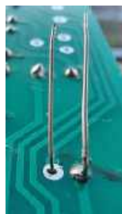
Fotografia 8. Montaż kondensatora elektrolitycznego C3: pamiętając o konieczności zachowania właściwej polaryzacji: a) zamontuj kondensator na leżąco; b) rozegnij lekko jego wyprowadzenia, aby nie wypadł po odwróceniu płytki do góry nogami; c) odegnij do pionu jedno z wyprowadzeń; d) przylutuj odgięte do pionu wyprowadzenie prostopadłe do płytki; e) odegnij do pionu drugie wyprowadzenie; f) przylutuj odgięte do pionu wyprowadzenie prostopadłe do płytki
