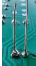
Fotografia 8. Montaż kondensatora elektrolitycznego C3: pamiętając o konieczności zachowania właściwej polaryzacji: a) zamontuj kondensator na leżąco; b) rozegnij lekko jego wyprowadzenia, aby nie wypadł po odwróceniu płytki do góry nogami; c) odegnij do pionu jedno z wyprowadzeń; d) przyłutuj odgięte do pionu wyprowadzenie prostopadłe do płytki; e) odegnij do pionu drugie wyprowadzenie; f) przyłutuj odgięte do pionu wyprowadzenie prostopadłe do płytki
