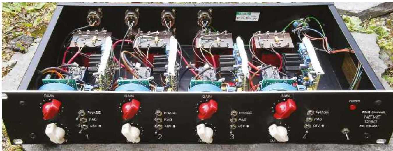
Rysunek 55. Kompletny przedwzmacniacz mikrofonowy „Neve”, zbudowany dla Eda Lewisa ze studia Giant Wafer. Zwróćmy uwagę na rzędek czterech transformatorów LO1166
