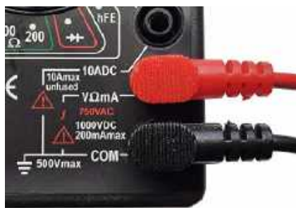
Fotografia 17. Poprawne podłączenie kabli na przykładzie multimetru DT-830B, ustawionego na funkcję woltomierza napięć statycznych
