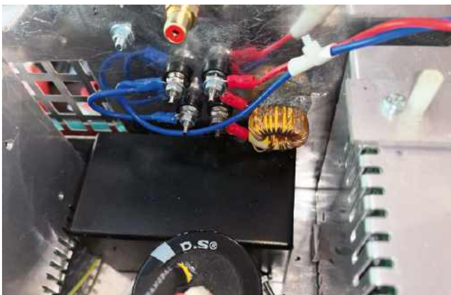
Fotografia 5. Wewnętrzne okablowanie wyjść głośnikowych z cewką 75 µH. Gniazdo wejściowe IEC znajduje się pod czarną skrzynką Jiffy i jest zabezpieczone śrubami i nakrętkami w podstawie obudowy, aby zapewnić izolację i separację od okablowania niższego napięcia powyżej
