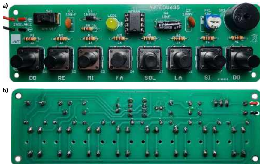
Fotografia 20. Poprawnie zmontowany układ Minipianina. Widok płytki a) od strony komponentów; b) od strony lutowania
