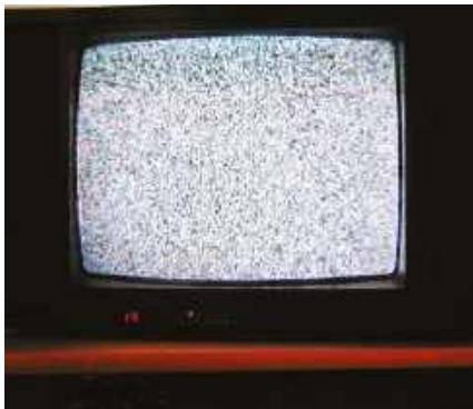
Rysunek 6. Telewizor z kineskopem, wyświetlający „statyczny” szum biały
