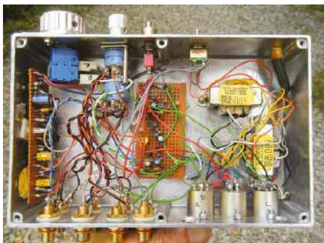
Rysunek 37. Wzmacniacz do monitorów studyjnych z transformatorami wyjściowymi Sowter 5069 Mumetal/M6. Obwód Zobla to 22 nF i 1,5 kΩ. Jest to ten sam transformator, który omawialiśmy w części 2, rysunek 30
