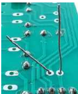
Fotografia 8. Montaż kondensatora elektrolitycznego C3: pamiętając o konieczności zachowania właściwej polaryzacji: a) zamontuj kondensator na leżąco; b) rozegnij lekko jego wyprowadzenia, aby nie wypadł po odwróceniu płytki do góry nogami; c) odegnij do pionu jedno z wyprowadzeń; d) przyłutuj odgięte do pionu wyprowadzenie prostopadłe do płytki; e) odegnij do pionu drugie wyprowadzenie; f) przyłutuj odgięte do pionu wyprowadzenie prostopadłe do płytki
