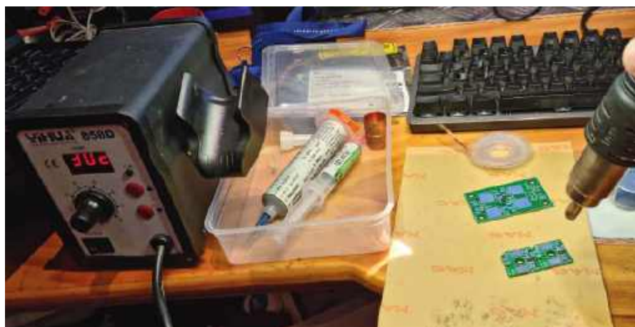
Lutowanie układu scalonego MSOP-12 LT4320 przy użyciu taniej stacji lutowniczej na gorące powietrze. Jest ona nieoceniona przy różnego rodzaju pracach, szczególnie ułatwia rozlutowywanie układów SMD. W tym przypadku wymarzoną cechą jest możliwość podgrzania układu scalonego na tyle, aby przylutować jego termiczny pad do płytki
