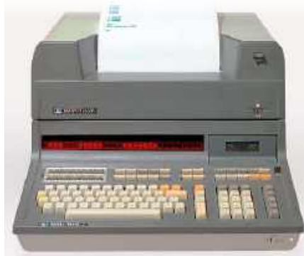
Rysunek 7. Programowalny kalkulator/komputer HP 9830A z 1972 roku, z drukarką termiczną, wykorzystywał układy pamięci Intel 1103 o pojemności 1 kB. Źródło: Hydrargyrum, https://w.wiki/5zxQ (GNU FDL)
