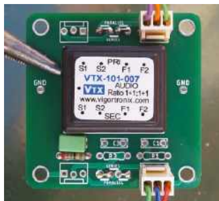
Rysunek 42. Płytkę wzmacniacza z wyjściem liniowym z transformatorem VTX-101-007 o uzwojeniach połączonych równolegle. Elementy obwodu Zobla to 1,3 kΩ i 6,8 nF
