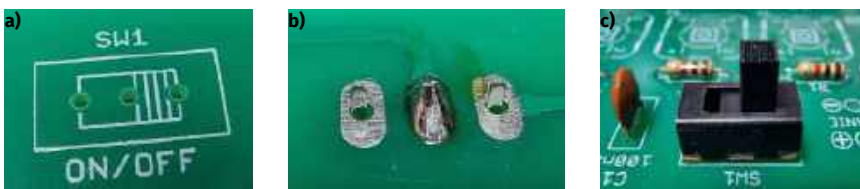
Fotografia 14. a) Sposób oznaczenia miejsca do zamontowania przełącznika SW1 na płytce drukowanej; b) zanim przylutujesz wszystkie wyprowadzenia, przylutuj w pierwszej kolejności pin środkowy i sprawdź, czy komponent przylega prostopadle do płytki. Jeśli wszystko jest w porządku przylutuj dwa pozostałe wyprowadzenia; c) tym sposobem przełącznik został poprawnie przylutowany i dobrze przylega do płytki
