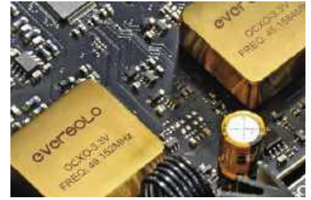
Złote osłony kryją precyzyjne układy zegarów taktujących.
