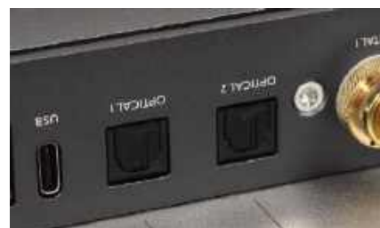
Złącza optyczne i USB działają już konwencjonalnie, wyłącznie jako cyfrowe wejścia.
