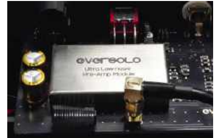
W metalowych osłonach zamknięto niskoszumowe wzmacniacze "Pre-Amp Module".
