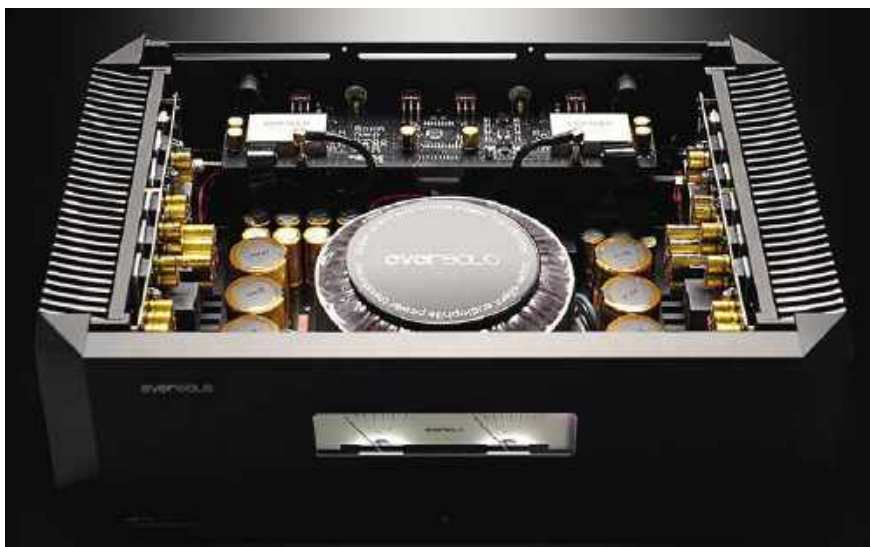
AMP-F10 to wzmacniacz w klasie AB, ale z oryginalną baterią tranzystorów MOSFET.
