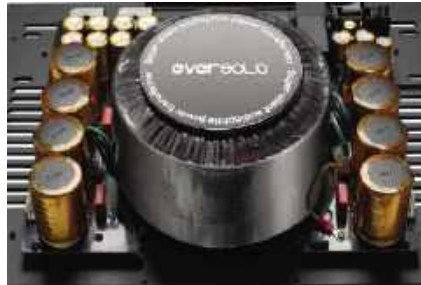
Transformator toroidany jest pojedynczy i obsługuje obydwie kanały, ale płytki stopni wyjściowych są niezależne.
