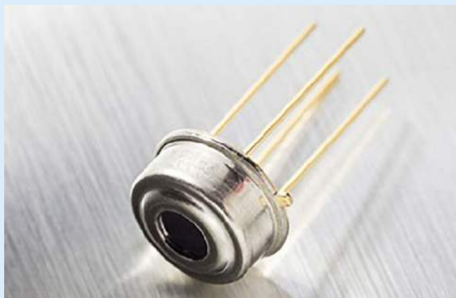
Fotografia 1. Czujnik MLX90614 firmy Melexis [8]
