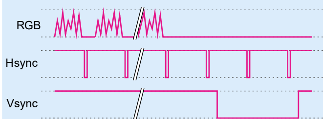
Rysunek 6. Synchronizacja pionowa (Vsync)
