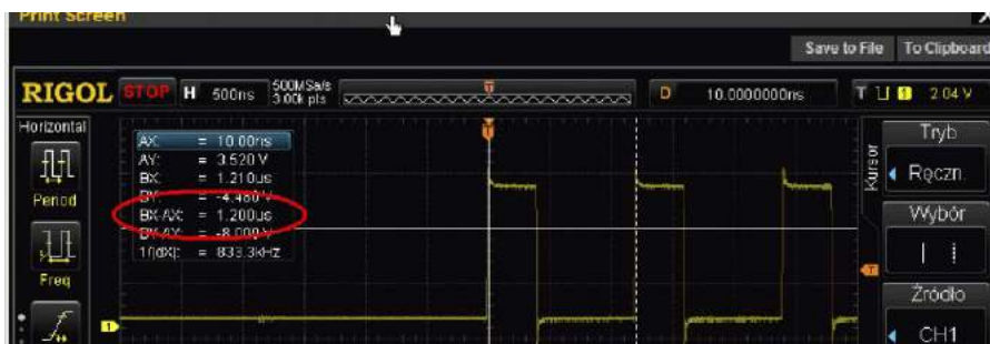
Rysunek 8. Zmierzona maksymalna przepływność interfejsu UART
