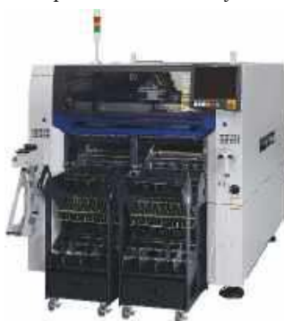
Fotografia 7. Ultrawydajny automat pick&place – YRM20DL marki Yamaha ( https://t.ly/KXsDF )
