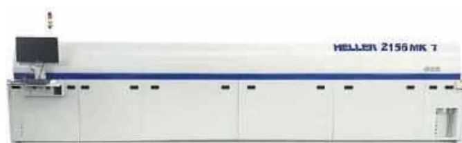
Fotografia 14. Piec rozpliwowy Heller Industries, model MK7 2156 (https://t.ly/gy0i0)
