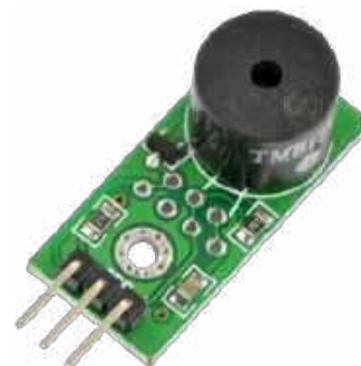
Fotografia 3. Moduł buzzera z generatorem MOD-04526 [9]
