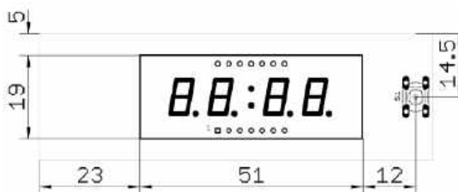
Rysunek 3. Położenie przycisku i wyświetlacza LED na powierzchni płytki drukowanej
