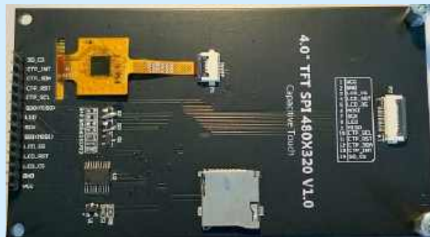
Fotografia 2. Widok tylnej strony płytki z wyświetlaczem
