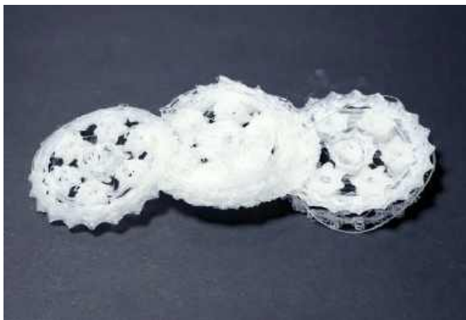
Fotografia 3. Nieudany wydruk z nylonu PA12 – w trakcie wydruku model oderwał się od blatu
