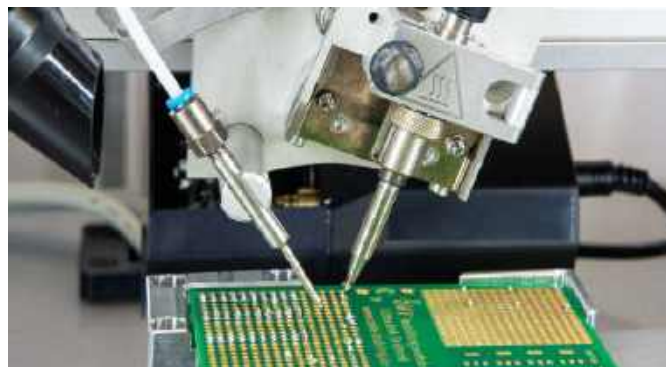
Fotografia 22. Robot lutowniczy SR 500 marki Ersy ( https://t.ly/2UaSj )
