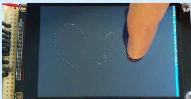
Fotografia 8. Efekt pracy testowego programu dla panelu dotykowego
