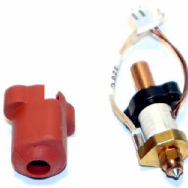
Fotografia 5. Zapasowa grzałka z dyszą, gardzielą i osłoną z silikonu
