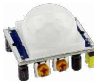
Fotografia 2. Czujnik ruchu PIR typu HC-SR501 [6]
