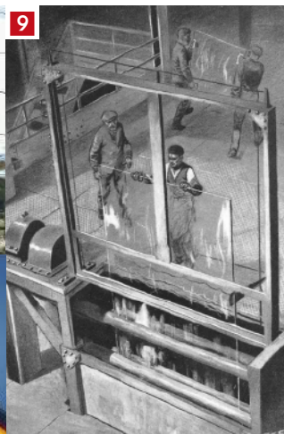
5. Wnętrze Pałacu Kryształowego w Londynie – ilustracja z czasów wielkiej wystawy; 6. Butelka wyprodukowana przez dziewiętnastowieczną maszynę firmy Ashley; 7. Szkło typu wire cast; 8. Produkcja tafli szklanych metodą Fourcaulta; 9. Produkcja tafli szklanych w kąpeli cynowej metodą Alastaira Pilkingtona
