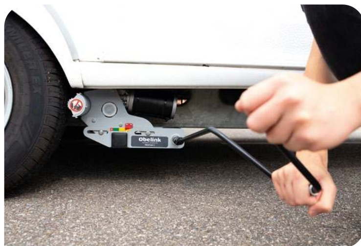
Proces dosuwania i odsuwania rolek jak wyżej. Obelink Prestige II jest prosty i nie wymaga dużej siły. Można też wykorzystać do tego celu wkrętarke
