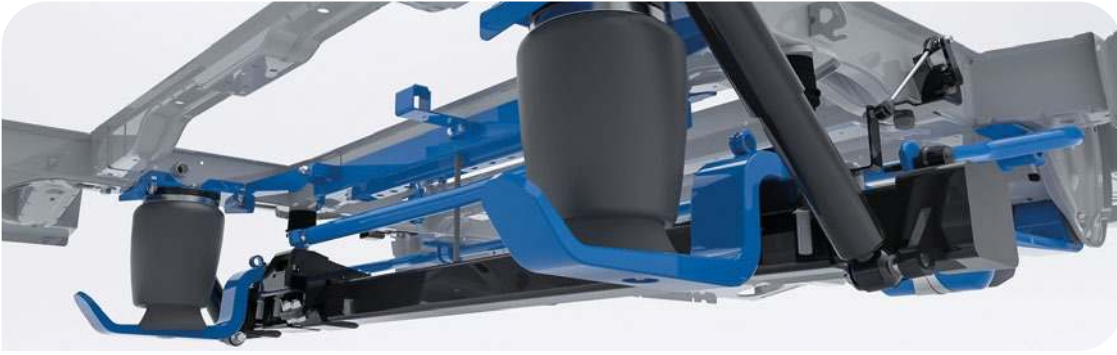
Tu szczegół konstrukcyjny pneumatyki zawieszenia, która pozwala zmodernizować pojazd, tj. dostosować go do większych obciążeń
