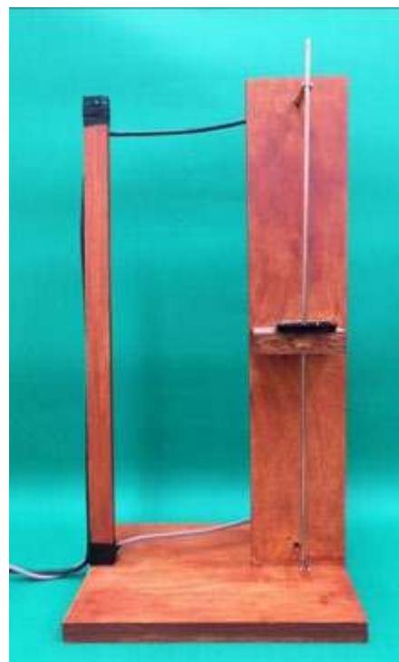
Fot. 1. Wygląd zewnętrzny fragmentu układu doświadczalnego z naczyniem zawierającym ferrofluid i konstrukcją nośną.
