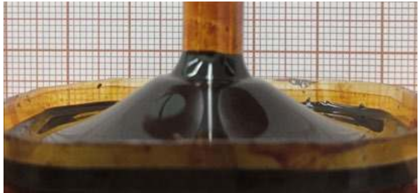
Fot. 3. Efekt Mojżesza w polu magnetycznym, wytwarzanym przez „pręcik” złożony z małych magnesów neodymowych, wsuwanych od dołu do rurki – kształt powierzchni swobodnej cieczy dla różnych położenia magnesu. Magnes jest widoczny u dołu for. 3.a.
