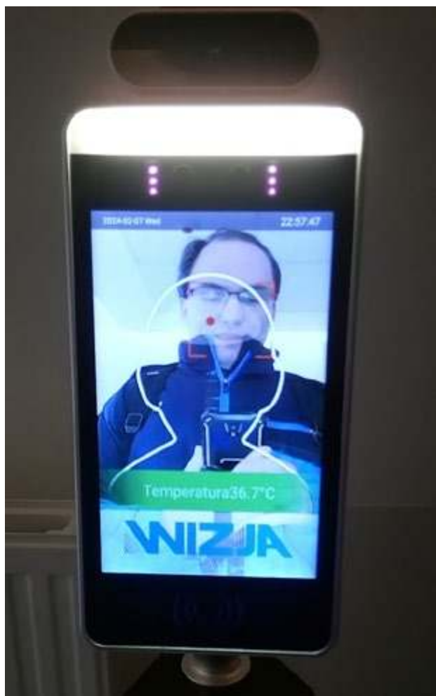
Fot. 6. Wyposażone w kamerę termowizyjną urządzenia do bezdotykowego pomiaru temperatury umieszczone są np. w placówkach ochrony zdrowia.
