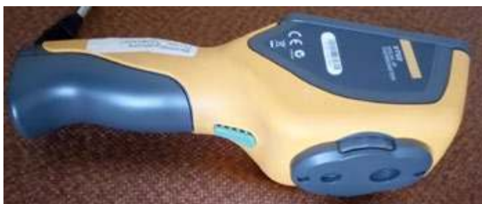
Fot. 4. Pirometr graficzny pozwalający zarejestrować mapę cieplną obiektu w podczerwieni i nałożyć ją na normalną fotografię.
