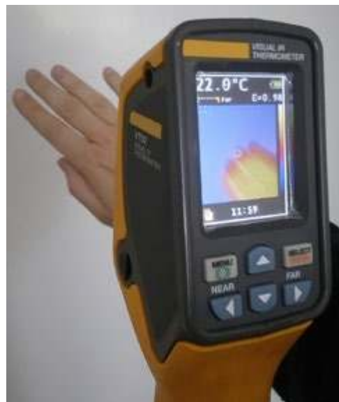
Fot. 3. Procedura rejestracji termogramu dłoni zdrowego człowieka ( \epsilon = 0,98 ).
