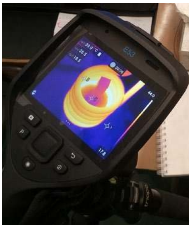
Fot. 5. Nałożenie obrazów zarejestrowanych w podczerwieni i w świetle widzialnym umożliwia wizualizację zarówno temperatury jak i konturów obiektu, w tym przypadku rozgrzanej cewki w eksperymencie z hipertermią magnetyczną.
