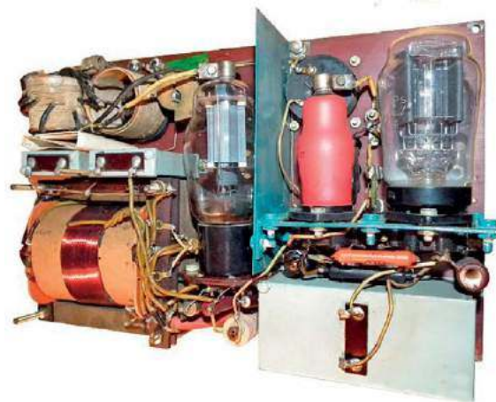
laczu sieciowym był zastosowany transformator sieciowy oraz lampa AZ1.
