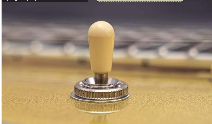
Jak przystało na LP, pickupy obsługuje 3-pozycyjny przełącznik, zamontowany w górnej części korpusu.
