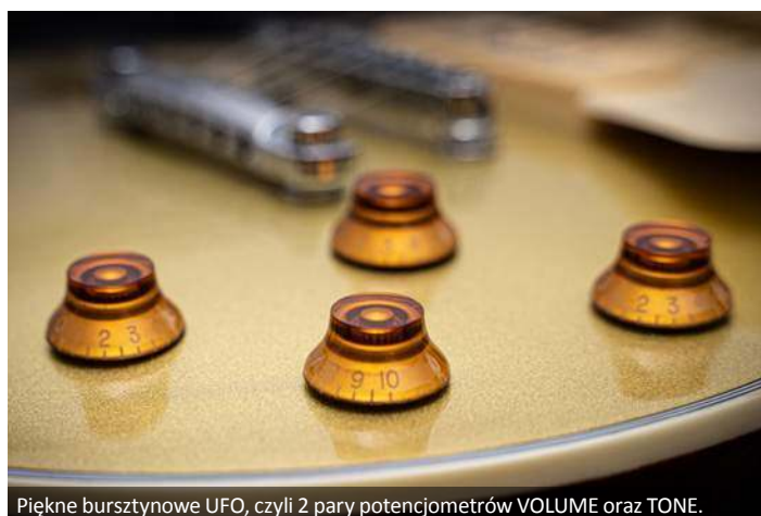
Piękne bursztynowe UFO, czyli 2 pary potencjometrów VOLUME oraz TONE.
