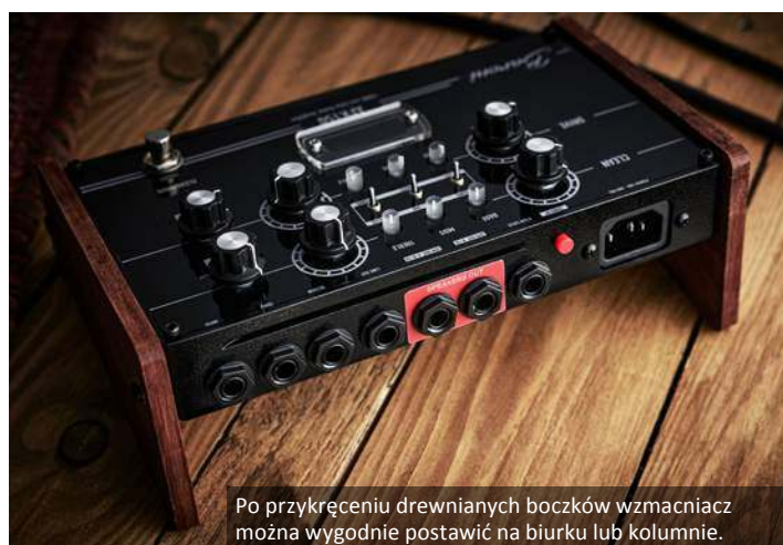
Gałki MASTER i PRESENCE służą do ustawienia końcowej głośności oraz prezencji.
