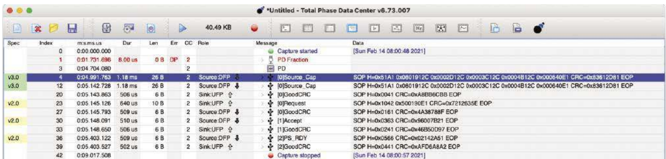
Rysunek 7. Górna połowa tego zrzutu ekranowego pokazuje komunikaty wymieniane między zasilaczem a obciążeniem podczas udanych negocjacji kontraktu 20 V. Dolna połowa pokazuje szczegóły podświetlonego komunikatu charakterystyki zasilacza („Source Cap”). W tym przypadku istnieje pięć schematów opisu mocy, odpowiadających pięciu poziomom napięcia obsługiwanych przez to źródło
