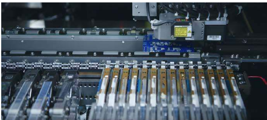
Fotografia 1. Automat pick&place w czasie montażu płytki drukowanej
