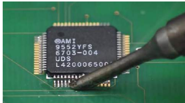
Podczas lutowania metodą przeciągania lutu zazwyczaj używa się grotu typu flow lub grotu skośnego. Najłatwiejszym sposobem na nauczenie się lutowania metodą przeciągania byłoby obejrzenie filmu, takiego, jakich wiele można znaleźć na YouTube Źródło: https://youtu.be/nyele3CIs-U
