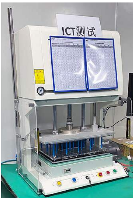
Fotografia 2. Stacja testowa ICT
