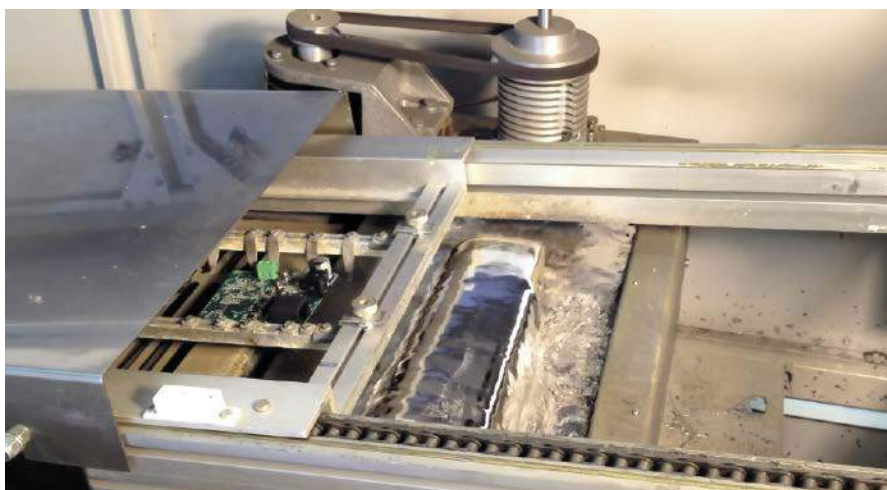
Przykład lutowania na fali pokazujący płytkę PCB opuszczającą część grzewczą maszyny i przenoszoną do wanny z falą lutowniczą. Źródło zdjęcia: https://youtu.be/VVH58QrprVc
