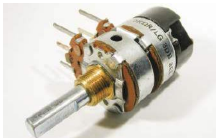
Rysunek 6. Specjalny potencjometr firmy Blore Edwards do regulacji wzmocnienia (VR1). To jest seria CTS 45, wykładniczy, podwójny, z wyłącznikiem
