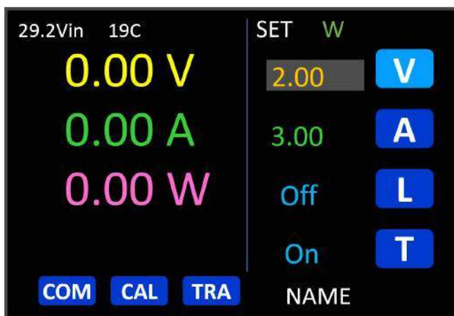
Ekran 3. Główny ekran, który pojawia się po włączeniu. Aktualne napięcie, prąd i moc są pokazane po lewej stronie, a napięcie wejściowe i temperatura radiatora powyżej. Ustawienia napięcia i prądu znajdują się po prawej stronie, a przyciski do włączania/wyłączania ograniczania prądu i śledzenia poniżej. Status urządzenia wyświetlany jest w prawym górnym rogu ekranu
