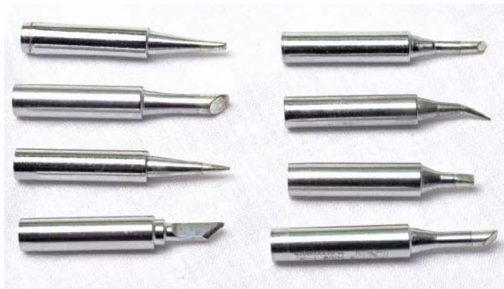
Niektóre popularne grotu lutownicze; większość z nich nadaje się do pracy z elementami SMD
