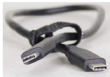
Wtyczki USB typu C mają więcej styków rozmieszczonych symetrycznie, dzięki czemu wtyczkę można włożyć dowolną stroną i połączenie nadal będzie działać
