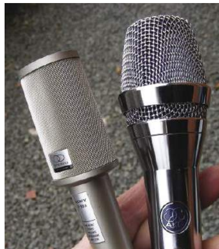
Rysunek 3. Tani mikrofon Sony F-99A 200 \Omega (po lewej) nie nadawał się wcześniej do użytku ze standardowymi przedwzmacniaczami mikrofonowymi, a nawet dobry mikrofon wokalny do występów na żywo AKG D7 LTD 600 \Omega wymagał dodatkowej charakterystyki wysokich częstotliwości. Obydwa dobrze działają z użyciem odpowiedniego przedwzmacniacza, takiego jak ten, który będziemy budować w przyszłym miesiącu
