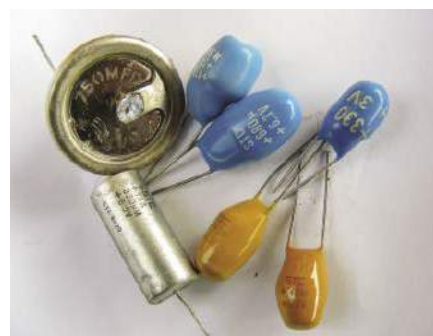
Rysunek 7. Kondensatory tantalowe oferujące wysokie wartości pojemności przy niskich prądach upływu (10...20 μA) – chociaż producenci tego nie gwarantują (powinieneś sprawdzić swoje komponenty!). Uzyskanie wystarczająco wysokich wartości (ponad 100 μF) może być trudne. Kondensator metalowy to montowany śrubowo kondensator typu mokrego Castanet, a kondensator osiowy to standardowy, solidny europejski TAA w metalowej obudowie, odpowiednik amerykańskiego CTS13
