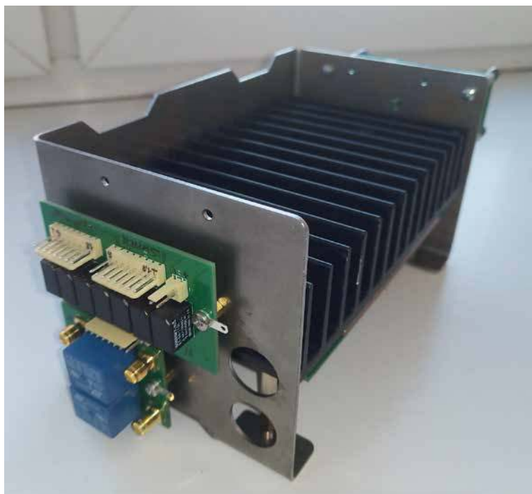
Boks płytki PA z zamocowanymi płytkami Auto-Manual i Bypass
