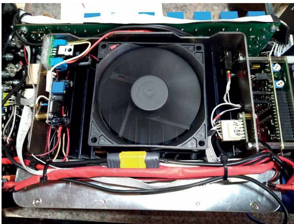
Zamontowana przetwornica DC-DC
