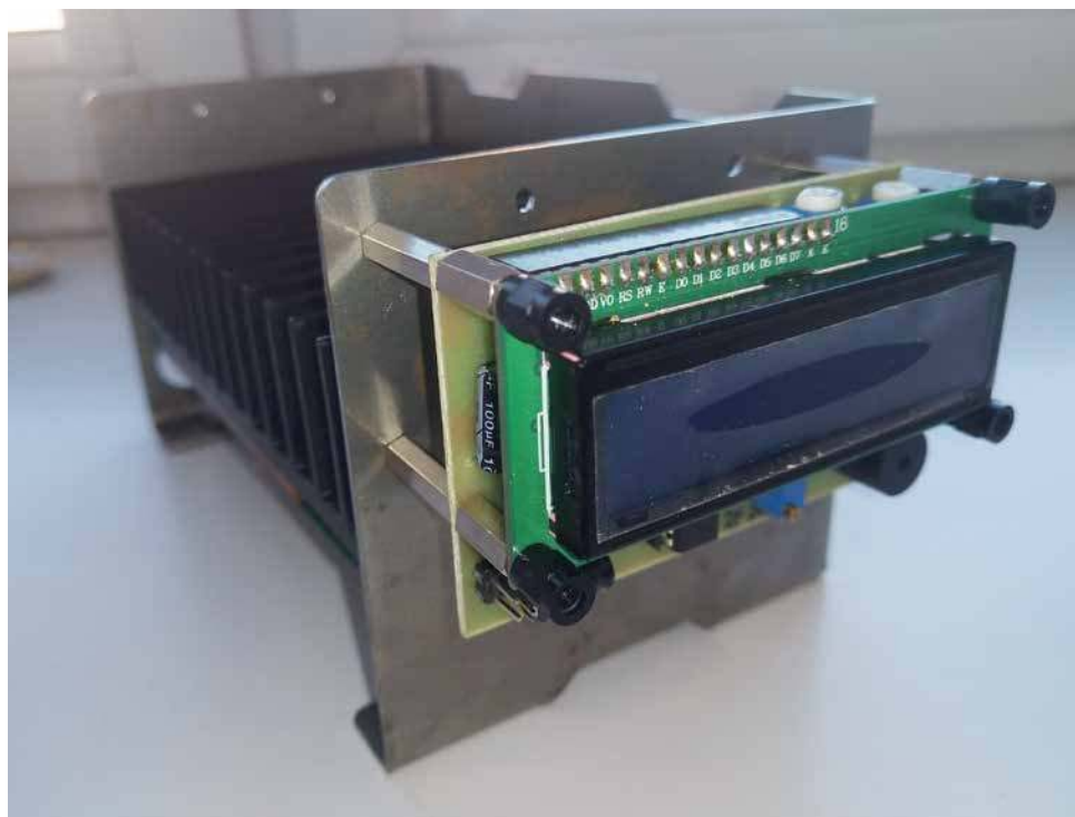
Boks płytki PA z zamocowaną płytką multimetru RF
