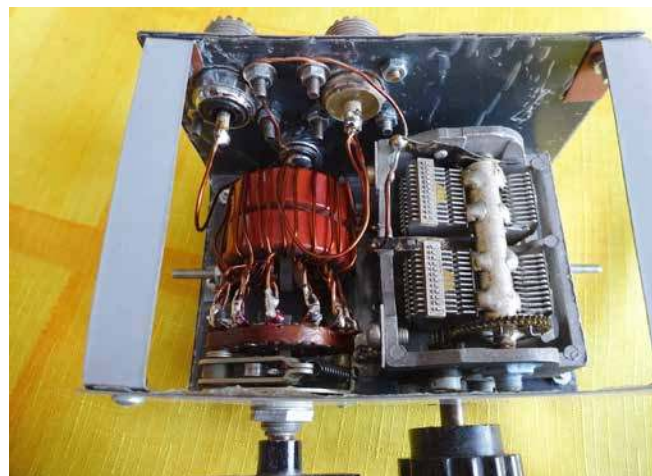
Wnętrze skrzynki do LW (home made)
