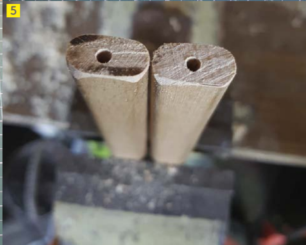
2. Korpus, wywierony otwór na wysięgnik duszy; 3. Drugi koniec korpusu zaostriamo co ułatwi wbicie go w ziemię; 4. Z listewki wycinamy suporty czasz dzwonka; 5. Suporty czasz dzwonka są nawiercone od czoła
