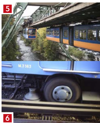
5. Schwebebahn w Wuppertalu współcześnie; 6. Pociąg na kołach z gumowymi oponami; 7. Birmingham maglev; 8. Zautomatyzowana linia metra D w Lyonie; 9. Linia kolejki maglev Incheon Airport w Korei Południowej
