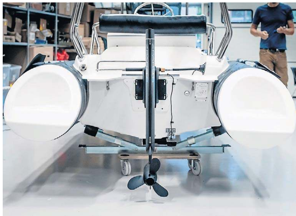
Ultrakompaktowy napęd Z10 ma ułatwić przejście floty na prąd: system ma mniej części, niższe koszty użytkowania i potencjał do szerokiego zastosowania
