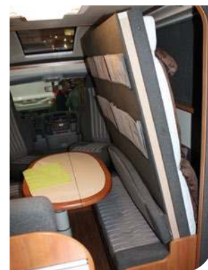
Zdjęcie nr 2 przedstawia salon w kamperze Van Exclusive 60KL z 2012 r. Wąska i niska kanapa jest odpowiednią raczej tylko dla dzieci, bo pierwszorzędnym walorem propozycji ma być uchylana ze ściany sypialnia na całej szerokości zabudowy. Skomplikowany mechanizm aranżacji takiego pośłania okupiony jest także sporym balastem, więc ładowność czteroosobowego pojazdu w gotowości do jazdy to tylko 373 kg
