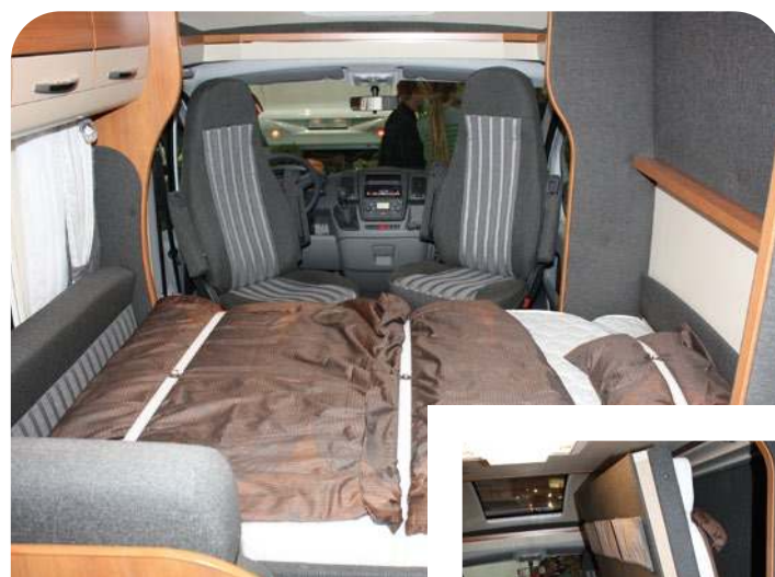
Zdjęcie nr 2 przedstawia salon w kamperze Van Exclusive 60KL z 2012 r. Wąska i niska kanapa jest odpowiednią raczej tylko dla dzieci, bo pierwszorzędnym walorem propozycji ma być uchylana ze ściany sypialnia na całej szerokości zabudowy. Skomplikowany mechanizm aranżacji takiego pośłania okupiony jest także sporym balastem, więc ładowność czteroosobowego pojazdu w gotowości do jazdy to tylko 373 kg
