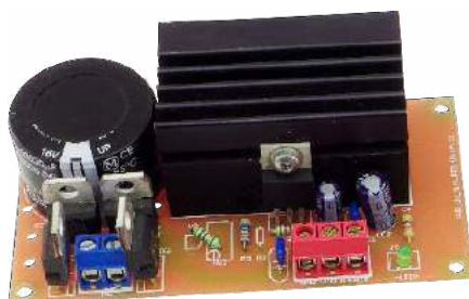
Fotografia 2. Zmontowany zasilacz napięcia żarzenia
