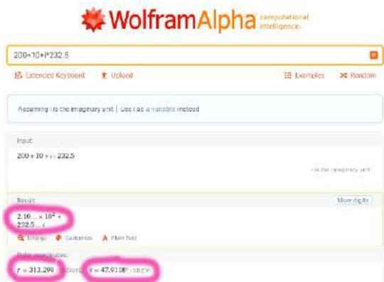
Rysunek 4. Przykładowe obliczenie impedancji w programie WolframAlfa
