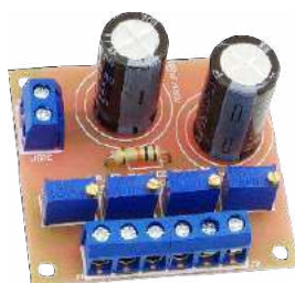
Fotografia 3. Zmontowany zasilacz napięcia siatkowego
