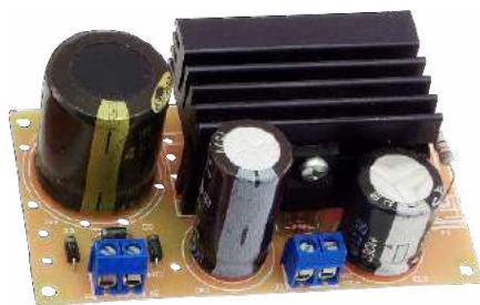
Fotografia 1. Zmontowany zasilacz napięcia anodowego
