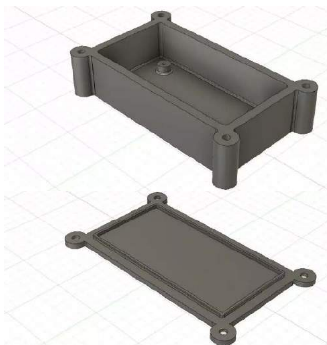
Rysunek 2. Obudowa do druku 3D, jaką zaprojektował i użył autor projektu
