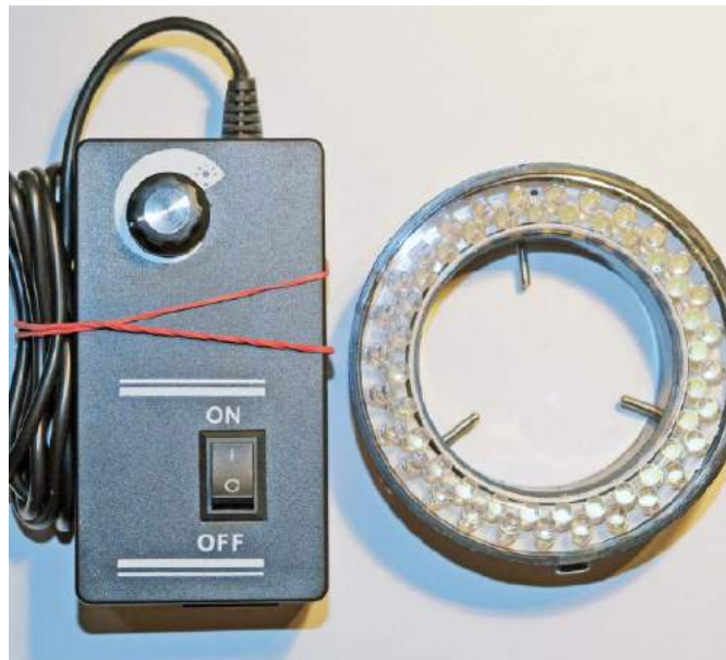
Fotografia 3. Pierścieniowa lampa podświetlająca
