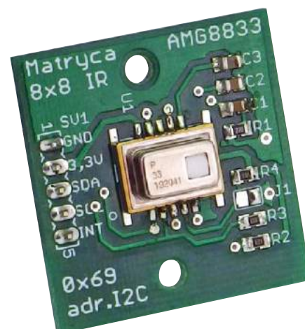
Fotografia 1. Widok modułu z czujnikiem AMG88xx
