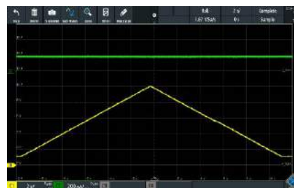
Rysunek 6. Wyniki pomiarów – zmiana napięcia testowanego układu zasilania przy stałym prądzie obciążenia
