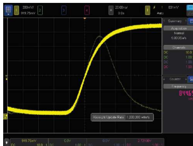
Rysunek 1. Przypadkowe zakłócenie wyświetlane na ekranie oscyloskopu o dużej szybkości przechwytywania obrazów
