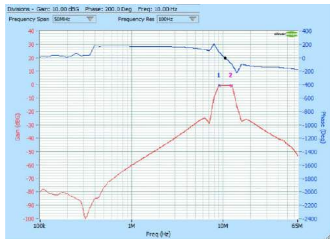
Rysunek 7. Przykład działania systemu FRA (Frequency Response Analysis)
