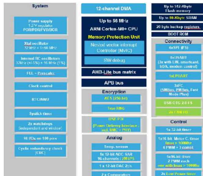
Rysunek 21. Schemat blokowy mikrokontrolera STM32G0A1
