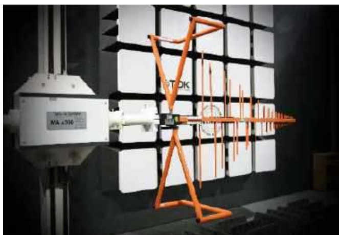
Fotografia 2. Wnętrze komory SAC – widoczna antena pomiarowa na kolumnie zmotoryzowanej oraz absorbery elektromagnetyczne (w tle)
