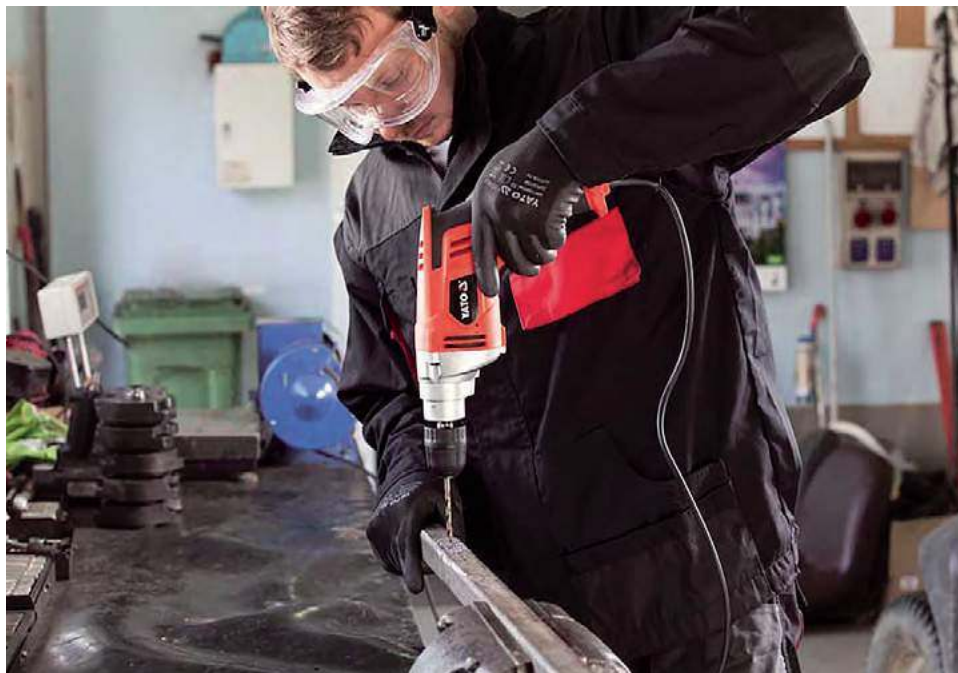
❶ Sieciowa wiertarka do metalu, z możliwością zmiany kierunku obrotów, bezstopniową regulacją prędkości obrotowej, ergonomicznym uchwytem i przewodem zasilającym w osłonie gumowej. TOYA (YATO)
