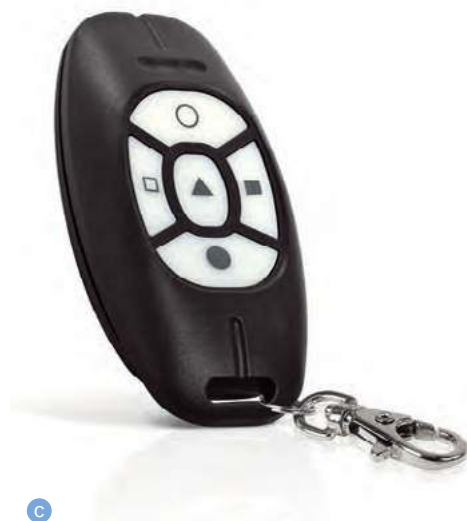
Urządzenia do komunikowania się z centralą: nowoczesny manipulator z dotykowym ekranem (a SATEL), brelok (b SOMFY), pilot do załączania/wyłączania alarmu i przywoływania ochrony (c SATEL).
