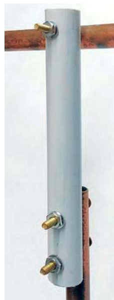
Rys. 10. Stabilizacja mechaniczna po drugiej stronie pętli
