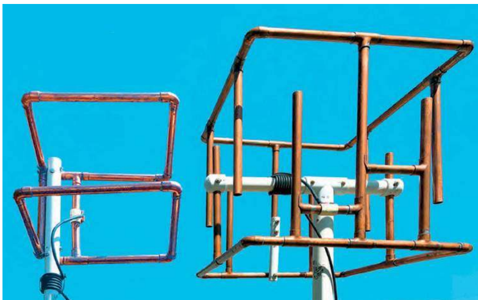
Rys. 4. Anteny szczelinowe na pasmo 2 m (z lewej) i udoskonalona wersja na pasmo 6 m (z prawej)
