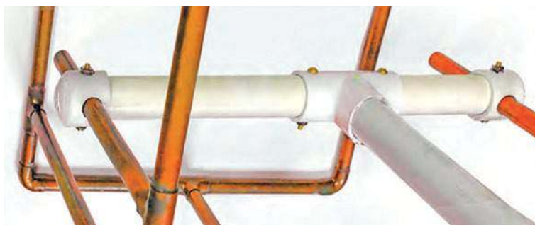
Rys. 9. Mocowanie anteny na maszcie
