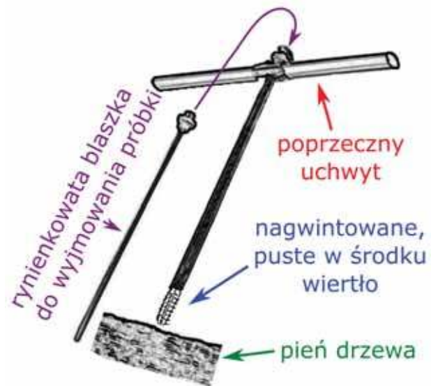
Rys. 1. Świder przyrostowy Presslera służy do pobierania próbek z pnia drzew.
