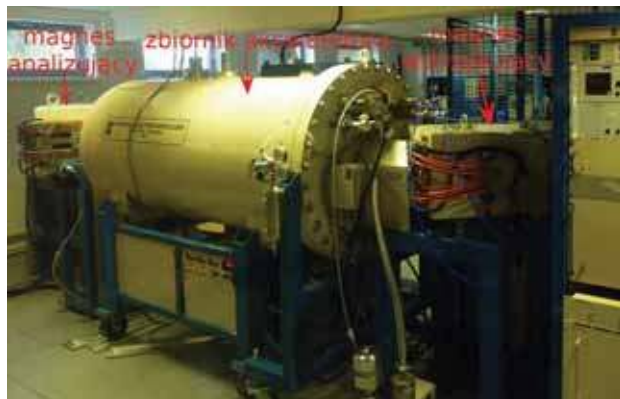
Fot. 2. Akcelerator typu pelletron znajduje się w zbiorniku wypełnionym heksafluorkiem siarki o bardzo dobrych właściwościach dielektrycznych.
