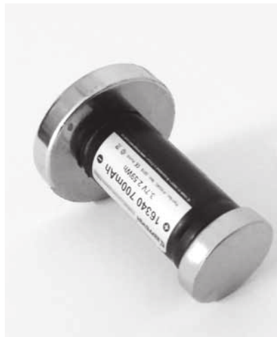
Fot. 3. Wagonik z walcowym akumulatorem litowo-jonowym.
