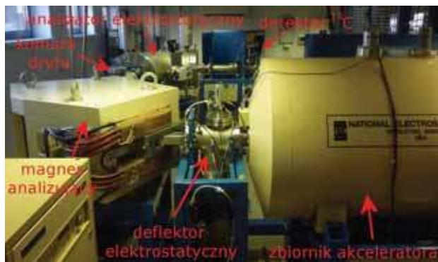
Fot. 3. Podstawowe elementy akceleratorowego spektrometru masowego, będącego na wyposażeniu laboratorium AMS na terenie Poznańskiego Parku Naukowo-Technologicznego.
