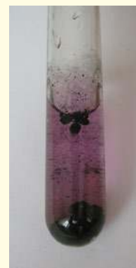
Doświadczenie 13. Reakcja Cruma (ciemny osad to pozostałości dwutlenku ołowiu i dwutlenku manganu).
