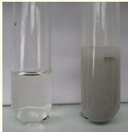
Doświadczenie 11. Z lewej roztwór soli cyny(II), z prawej zawartość probówki po dodaniu roztworu soli bizmutu(III) – widoczny wytrącony osad metalicznego bizmutu.
