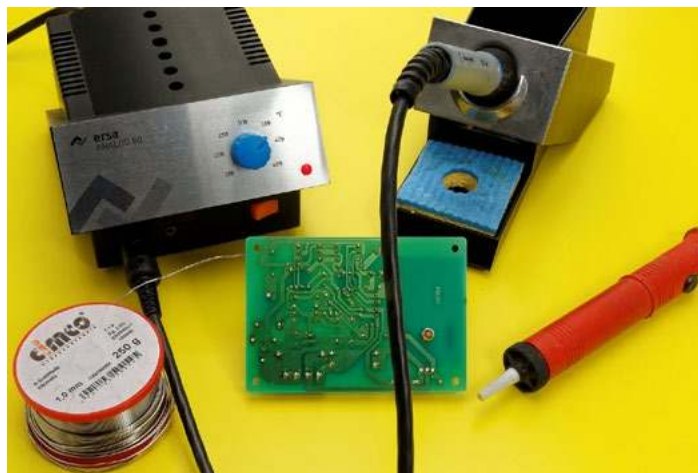
Lut cynowo-ołowiowy (60 % Sn, 40 % Pb) nadal znajduje się w powszechnym użyciu. Licencja Pixabay: ( https://pixabay.com/pl/photos/lutowanie-stacja-lutownicza-cyna-1038518/ )
