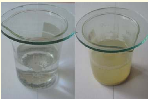
Doświadczenie 14. Z lewej początek doświadczenia (na dnie kawałki drutu lutowniczego), z prawej zawartość zlewki po kilku dniach (widoczne zmętnienie pochodzi od uwodnionych tlenków cyny(IV)).
