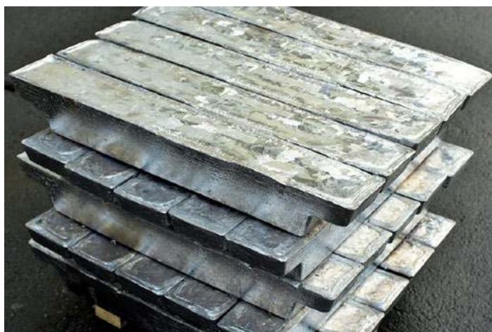
Bloki ołowiu – uboczny produkt podczas otrzymywania miedzi (własność KGHM Polska Miedź S.A.). Własność KGHM Polska Miedź S.A. ( https://kg hm.com/sites/kg hm2014/files/gallery-imag es/huta_miedzi_legnica_olow_0.jpg )
