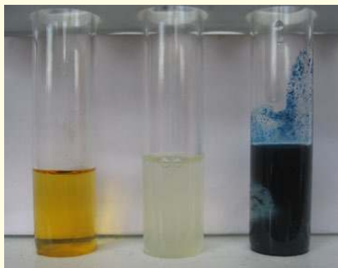
Doświadczenie 12. Z lewej roztwór chlorku żelaza(III) przed reakcją, w środku zawartość probówki po dodaniu roztworu soli cyny(II), z prawej błękit pruski powstający po dodaniu roztworu heksacyjanożelazianu(III) potasu świadczy o obecności jonów żelaza(II) w mieszaninie poreakcyjnej.
