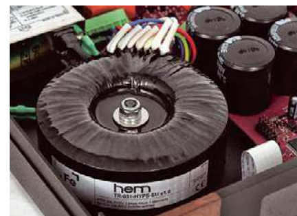
Duży ekranowany transformator toroidalny należy do sekcji liniowej.
