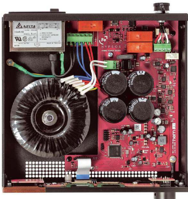
Wnętrze wygląda raczej jak w DAC-u, oprócz sekcji zasilającej widać rozbudowaną elektronikę cyfrową.
