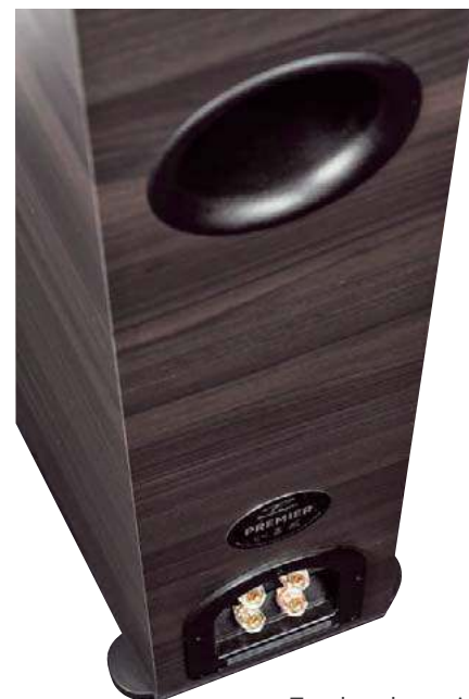
Tunel o relatywnie dużej powierzchni (jak na współpracę z parą 15-tok) ma krótki tunel, układ rezonansowy bas-refleks jest dostrojony dość wysoko, ale optymalnie przy danych parametrach głośników.
