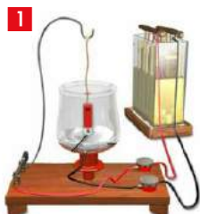
1. Model silnika elektrycznego Faradaya, 2. Rysunek eksperymentu Petera Barlowa, 3. Rysunek silnika Moritza Jacobi
