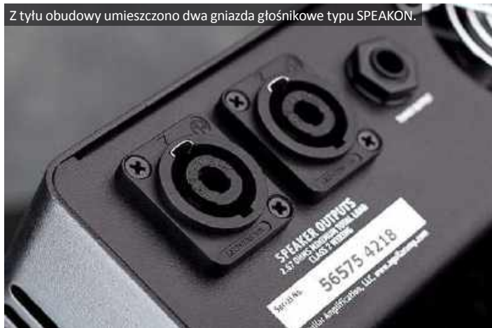
Z tyłu obudowy umieszczono dwa gniazda głośnikowe typu SPEAKON.
