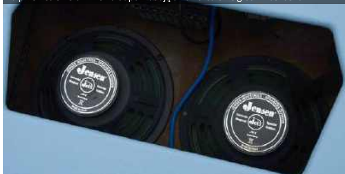
Za przeniesienie brzmienia odpowiadają dwa 10-calowe głośniki Jensena.
