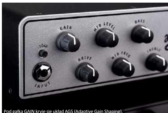
Pod gałką GAIN kryje się układ AGS (Adaptive Gain Shaping).
