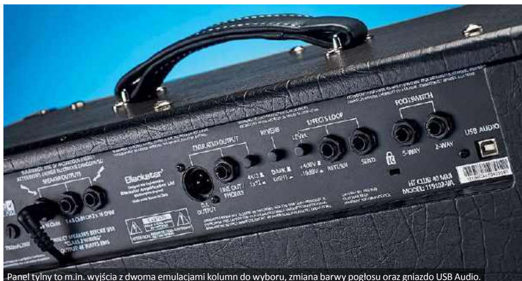
Panel tylny to m.in. wyjścia z dwoma emulacjami kolumn do wyboru, zmiana barwy pogłosu oraz gniazdo USB Audio.
