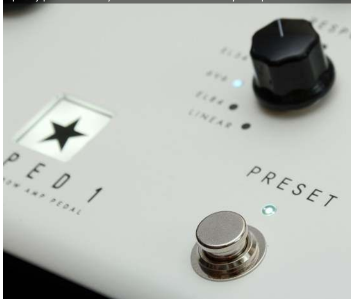
Prawy przycisk nożny przełącza pomiędzy trybem manualnym a zapisanym w aplikacji presetem z wszystkimi ustawieniami widocznymi na panelu.
