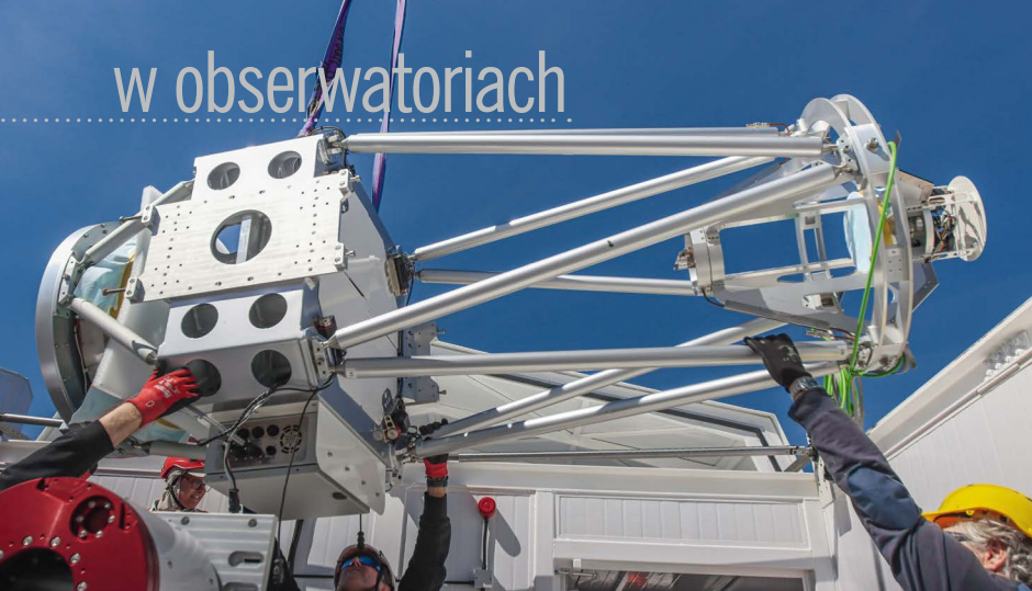
Główne lustro PoET do obserwacji szczegółów powierzchni Słońca ma 60 cm średnicy. Do analiz całej gwiazdy wystarczy teleskop o średnicy dziesięciokrotnie mniejszej.
