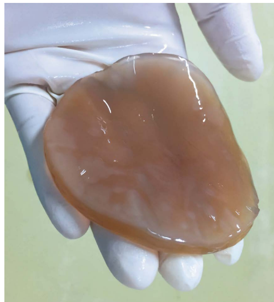
Celuloza bawełniana przetworzona przez bakterie i potraktowana NaOH
