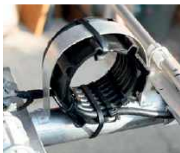
Rys. 1. Różne konstrukcje dławików antenowych
