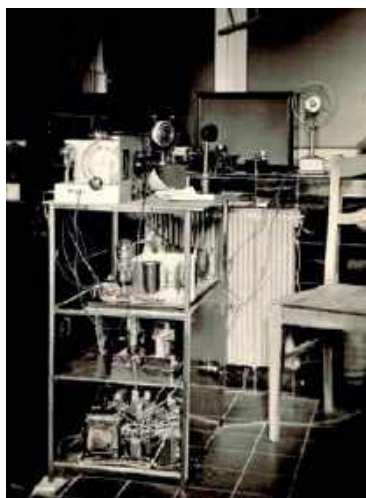
Stojak w parostopniowym nadajniku na pionowym stelażu
