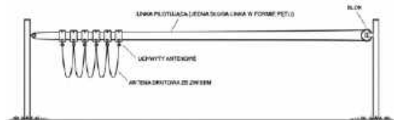
Rys. 3. Koncept z użyciem podwójnej linki pilotującej i przesuwania uchwytów
