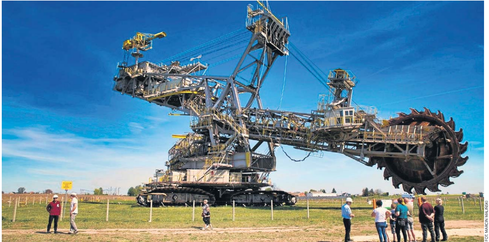
Waga Dolores to prawie 2700 ton, długość to 118 metrów, a wysokość to 38 metrów. Jest wyższa od 11-piętrowego wieżowca mieszkalnego
