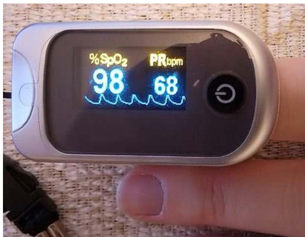
Fot. 1. Na wyświetlaczu pulsoksymetru pokazane są wartości pulsu (PR bpm), wysycenia krwi tlenem (% SpO 2 ) oraz krzywa pletyzmograficzna.
