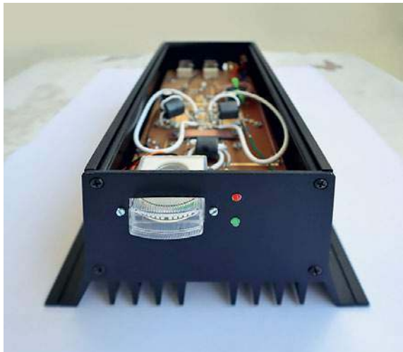
Fot 3. Z przodu wzmacniacza mocy znajdują się diody LED i wskaźnik analogowy
