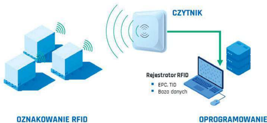
Rys. 1. Zasada działania RFID
