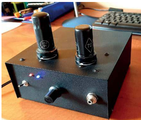
Widok ogólny wzmacniacza (lampy – po prawej trioda, po lewej pentoda)
