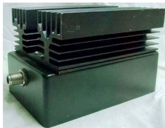
Sztuczne obciążenie z zewnątrz
