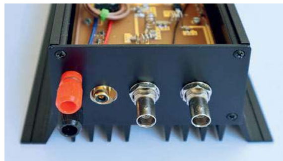
Fot 2. Z tyłu wzmacniacza mocy znajdują się wszystkie gniazda połączeniowe
