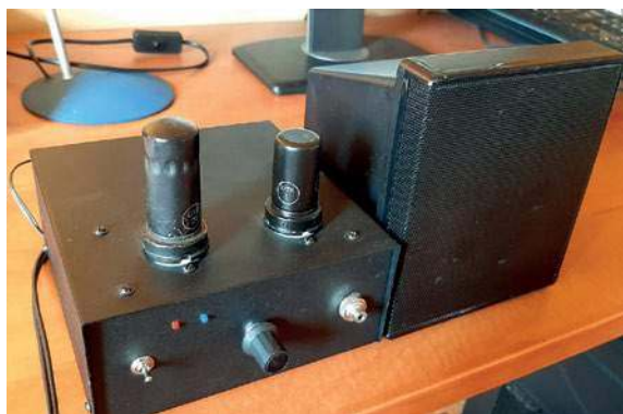
Widok wzmacniacza z wykorzystywanym głośnikiem (wyłącznik sieciowy, potencjometr siły głosu, gniazdo słuchawkowe, diody LED sygnalizacyjne napięć zasilających)
