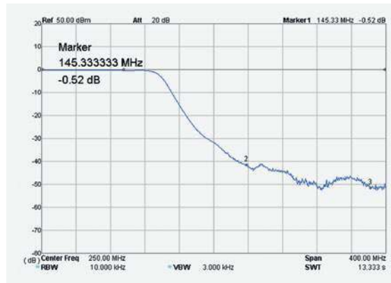
Rys. 5. Charakterystyka tłumienia filtra dolnoprzepustowego
