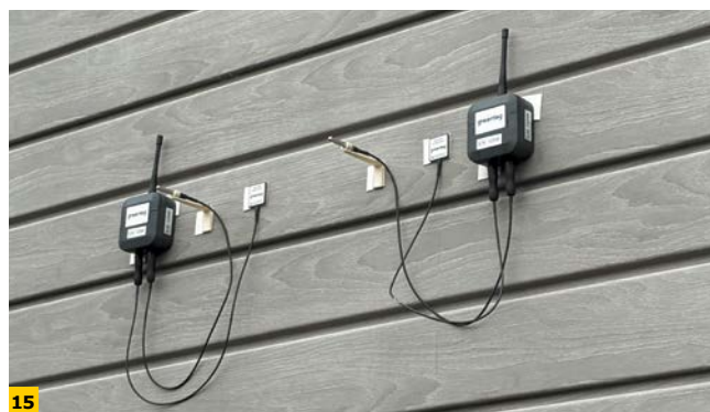
FOT. 12–15 Czujniki jakości powietrza wewnętrznego firmy Nuvap (12), miernik mikroklimatu (13) oraz czujniki do pomiaru współczynnika przenikania ciepła przegród w warunkach rzeczywistych firmy Greenteg na wewnętrznej i zewnętrznej ścianie budynku (14, 15); fot.: archiwum autorek
