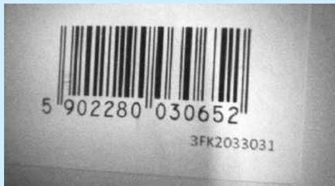
Fotografia 6. Obraz zarejestrowany przez kamerę skanera podczas prezentacji kodu wydrukowanego na etykiecie termicznej
