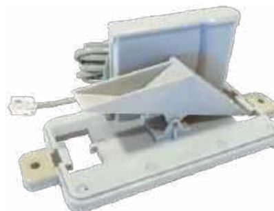
Fotografia 4. Czujnik opadów po zdjęciu obudowy [3]
