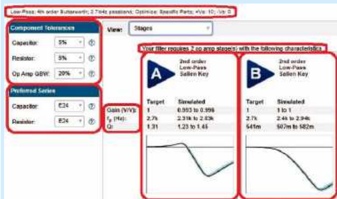
Rysunek 8. Właściwości poszczególnych stopni amplifiltru LPF typu Sallen-Key z uwzględnieniem tolerancji użytych elementów
