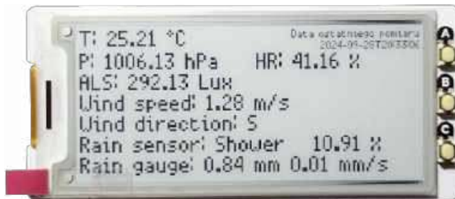
Fotografia 6. Przykład pomiaru podczas niewielkich opadów deszczu i wiatru
