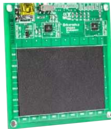
Fotografia 5. Zestaw ewaluacyjny DM160219 firmy Microchip ( https://t.ly/2xDGU )
