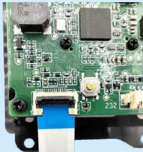
Fotografia 8. Prawidłowo umieszczona końcówka przewodu FPC w złączu ZIF modułu skanera. Montując przewód, należy zwrócić uwagę, czy wycięcia w usztywniaczu trafily na specjalnie przewidziane do tego celu miejsce wewnątrz gniazda ZIF
