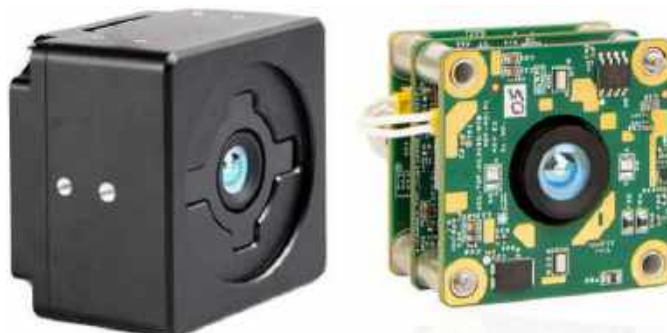
Fotografia 14. Przykład komercyjnego modułu kamery iToF ( https://t.ly/NsYtA )
