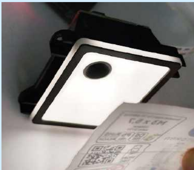
Fotografia 3. Moduł EM20-80 V2 w czasie skanowania wydrukowanego kodu QR
