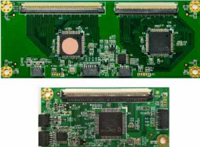
Fotografia 4. Przykładowe moduły kontrolerów wielodotykowych paneli rezystancyjnych ( https://t.ly/-iA-r )
