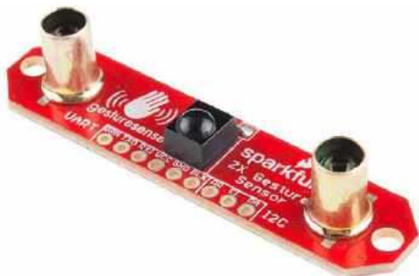
Fotografia 11. Moduł czujnika gestów na bazie nadajników IR i scalony odbiornik podczerwieni ( https://t.ly/HyFW2 )
