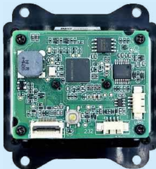
Fotografia 2. Widok PCB skanera od tyłu
