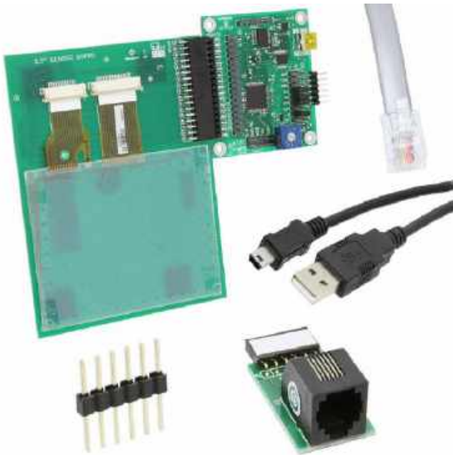
Fotografia 6. Zestaw ewaluacyjny DM160211 firmy Microchip ( https://t.ly/irwvL )
