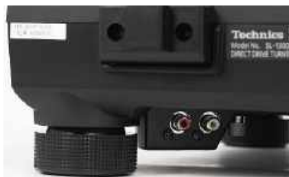
Pod plintą schowano gniazdo zasilające i złącza RCA (wraz z trzpieniem uziemienia).
