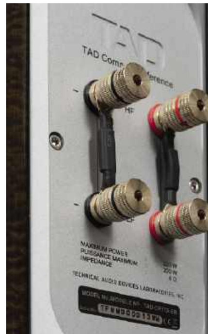
Panel podwójnego terminala przyłączeniowego to jednocześnie solidna baza filtrów sekcji średnio-wysokotonowej.
