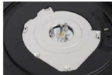
Napęd bezpośredni całkowicie zabudowano w plincie.
