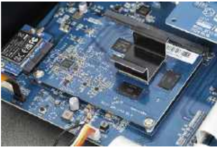
Typowy dla takich rozwiązań wydajny procesor ARM zarządzany zmodyfikowanym systemem operacyjnym Android.
