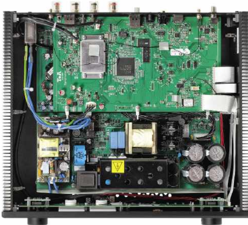
Wnętrze jest uporządkowane, a układy audio podzielone pomiędzy dwoma dużymi poziomymi płytkami.
