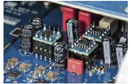
Tuż za nim widać autorskie systemy filtrów analogowych HiFi Rose NRA, oparte na scalonych wzmacniaczach operacyjnych.
