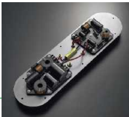
Zwrotnica została podzielona między płytki (drukowane) niezależne dla każdej sekcji.
