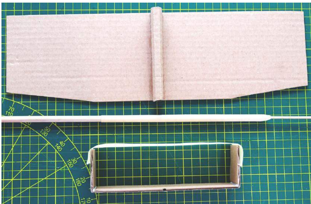
4. Taśma malarska pomoże zachować założone kąty. Kadłub dosycha. Pylon podskrzydłowy, po przymierzeniu do kadłuba, przykleja się do skrzydeł. Można użyć kleju na gorąco – ale magicznie też daje radę
