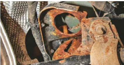
STAŁOWE ELEMENTY tylnego zawieszenia nie powinny tak wyglądać w tak młodym aucie.
