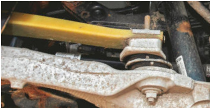
KOMPOZYTOWY RESOR poprzeczny na tylnej osi zastępuje sprężyny. To nietypowe rozwiązanie okazuje się tutaj naprawdę trwałe.
