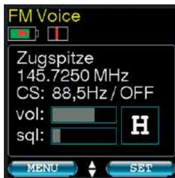
Fot. 2. Ekran przy pracy fonia
